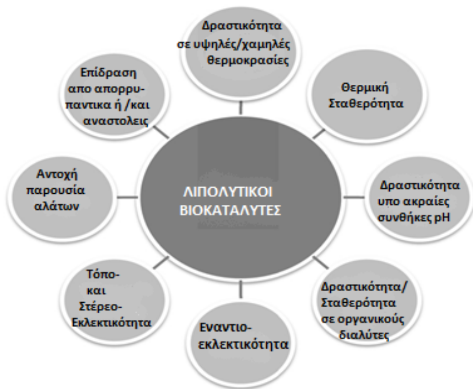
Εικόνα 4: Φυσικοχημικές ιδιότητες βιομηχανικών λιπολυτικών ενζύμων. Στη εικόνα εμφανίζονται τα κυριότερα χαρακτηριστικά των λιπολυτικών ενζύμων που τα διακρίνουν από τις άλλες κατηγορίες ενζύμων. (Slack, J.2001)
