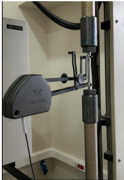
Εικόνα 3.7 Αρπάγες εφελκυσμού με εγκατεστημένο το επιμηκυσιόμετρο.
