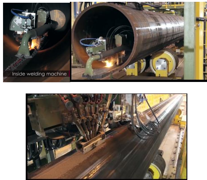
Εικόνα 1.16 Κύρια συγκόλληση LSAW (Longitudinal Submerged Arc Welding) στην εσωτερική (άνω μέρος) και στην εξωτερική πλευρά (κάτω μέρος) του σωλήνα [43].
