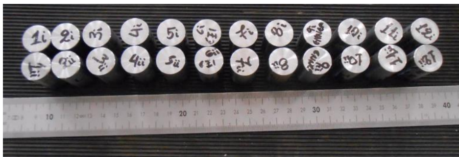
Εικόνα 3.2 Δοκίμια συμπίεσης κυλινδρικής μορφής σύμφωνα με το πρότυπο ASTM E9.
