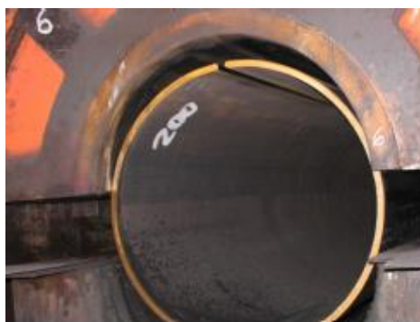
Εικόνα 1.33 Απελευθέρωση φορτίου πρέσας και φαινόμενο «springback» στο στάδιο «O» της διαμόρφωσης του σωλήνα [63].
