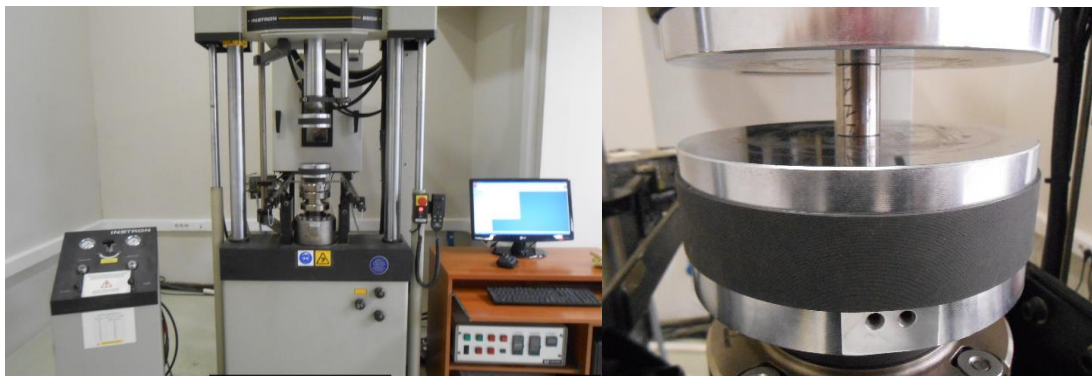
Εικόνα 3.4 Σερβουδραυλικό μηχάνημα INSTRON 8802, Αριστερά: γενική άποψη, Δεξιά: εστίαση στις πλάκες σύνθλιψης.
