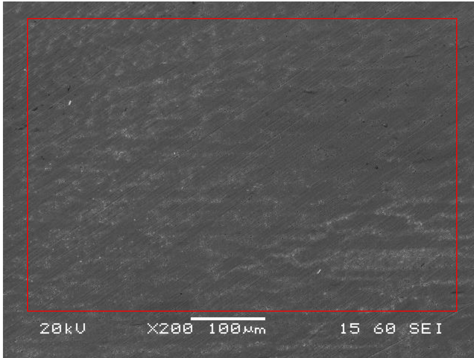
Εικόνα 78. Ηλεκτρονική μικρογραφία σάρωσης δευτερογενών ηλεκτρονίων της διαβρωμένης επιφάνειας του δοκιμίου WZ. Διακρίνεται η δενδριτική ανάπτυξη της ζώνης τήξης με ανομοιόμορφη κατευθυντικότητα δενδριτών.
