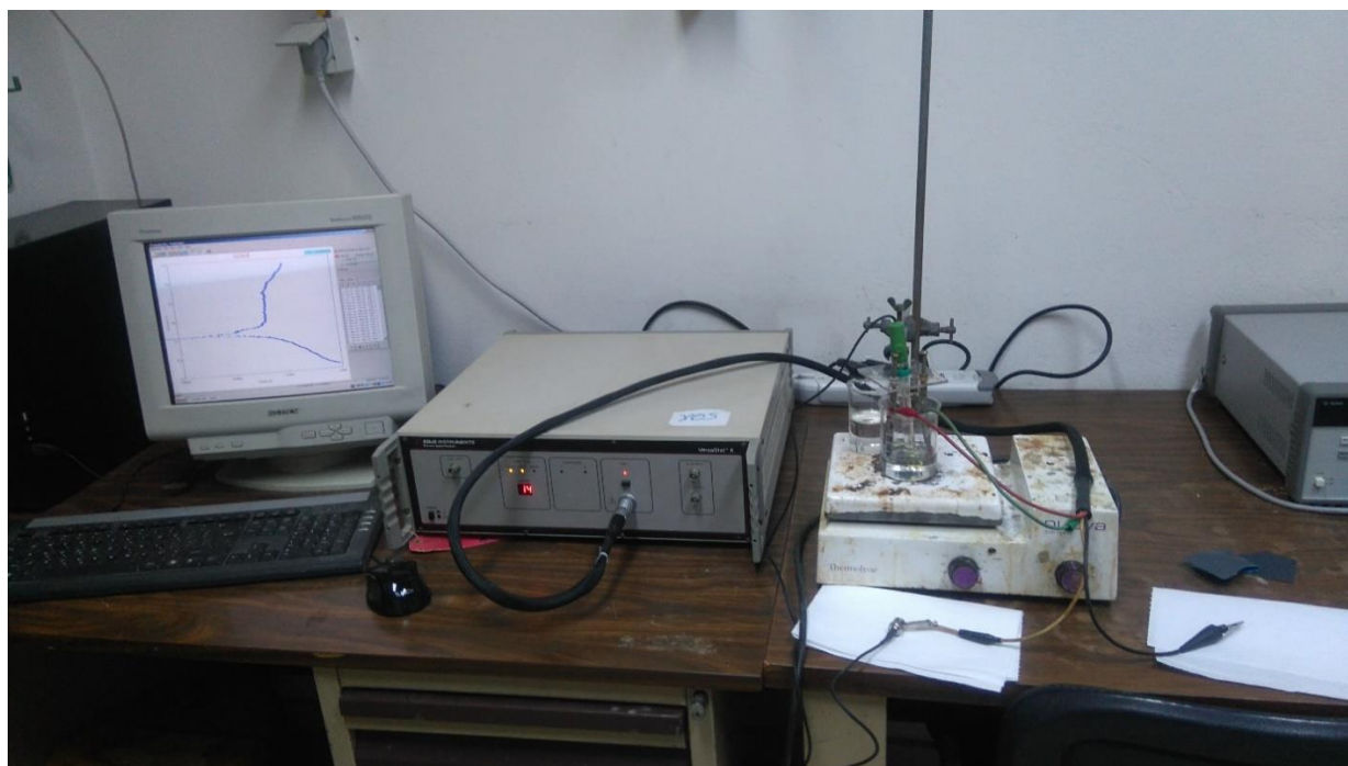
Εικόνα 29. Αναπαράσταση της πειραματικής διάταξης. Απαρτίζεται από το ηλεκτρολυτικό κελί, το οποίο έχει τοποθετηθεί πάνω σε έναν μαγνητικό αναδευτήρα που επιτρέπει τη ρύθμιση της θερμοκρασίας του ηλεκτρολύτη (hotplate stirrer), τον ποτενσιοστάτη και έναν υπολογιστή για την καταγραφή των διαγραμμάτων ποτενσιοδυναμικής πόλωσης.
