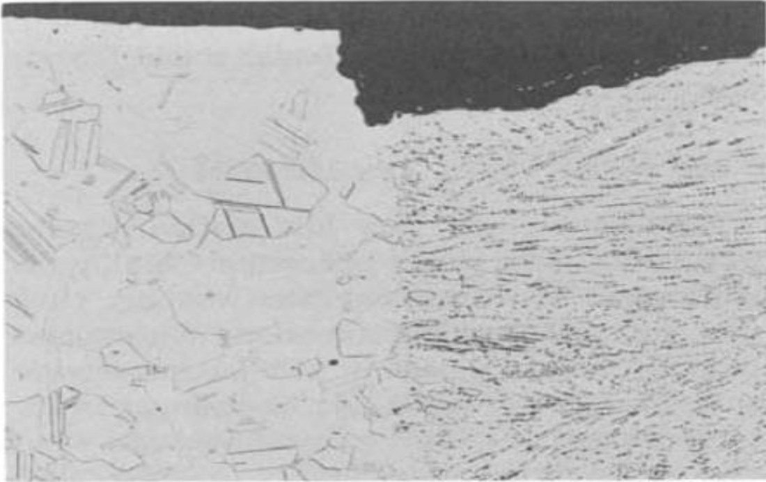
Εικόνα 24. Μικρογραφία δοκιμίου υπερκράματος B-42 (UNS N10665) σε κάθετη τομή (μεγέθυνση x75). Παρατηρείται προτιμητέα προσβολή της ΖΤ, ύστερα από έκθεση σε περιβάλλον χημικών αποβλήτων για περίπου 1 χρόνο [33].
