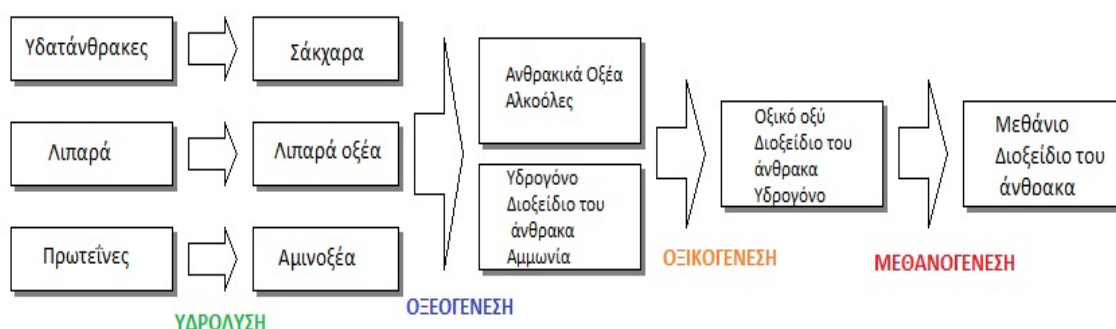
3-2: Διαγραμματική απεικόνιση διεργασιών της αναερόβιας χώνευσης
