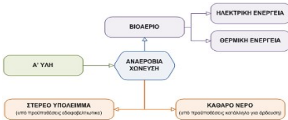
3- 1: Διάγραμμα ροής συνολικής διεργασίας αναερόβιας χώνευσης (Agroenergy S.A.)
