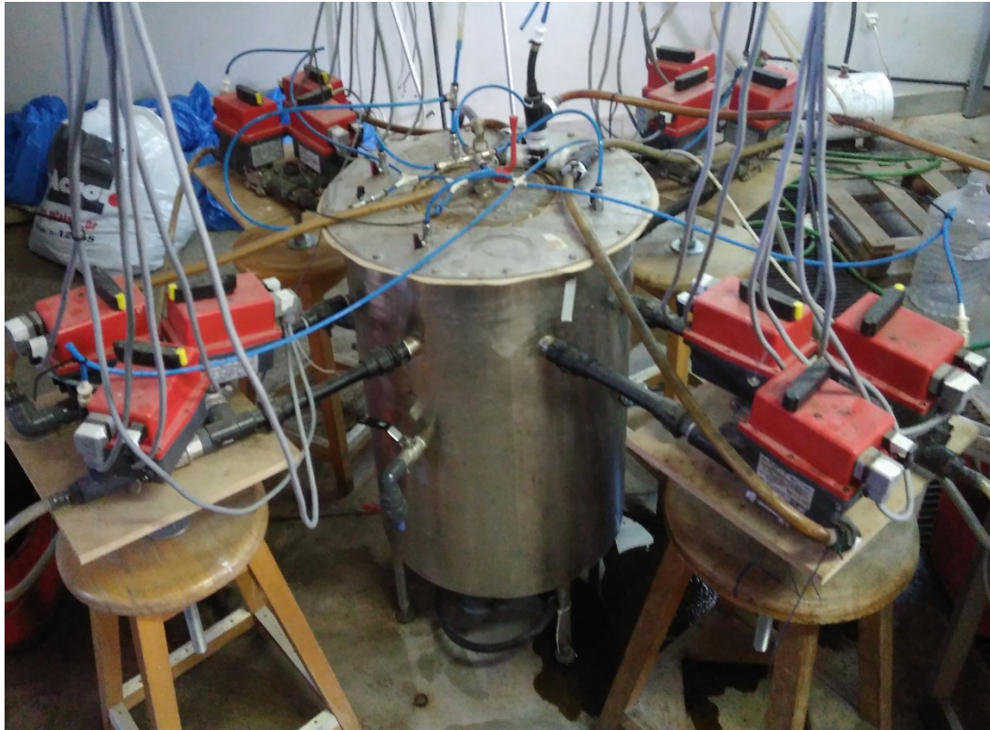
4-4: Συνολική εικόνα του πιλοτικής κλίμακας PABR και των ηλεκτροβανών του
