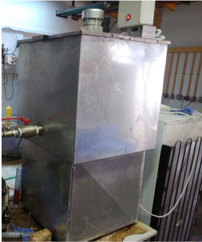
4-7: Εικόνα του ψυγείου τροφοδοσίας όπου φαίνεται και ο ενσωματωμένος αναδευτήρα
