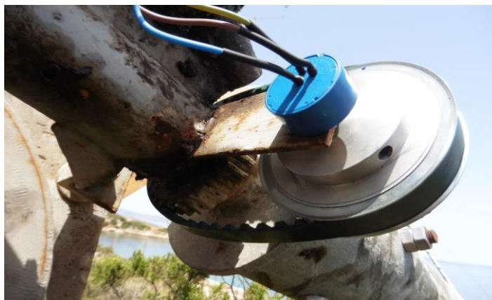
Εικόνα 43: Αισθητήρας μέτρησης της γωνίας yaw.
