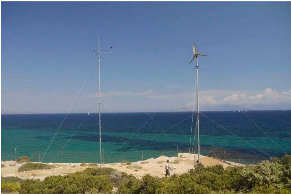
Εικόνα 45: Το πεδίο δοκιμών στη Ραφήνα, ο μετεωρολογικός ιστός και η ανεμογεννήτρια
