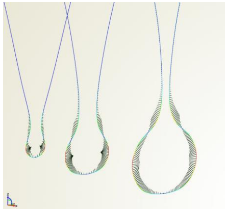
Εικόνα 34: Καμπυλότητα εγκάρσιων τομών αρχικής επιφάνειας βολβού
