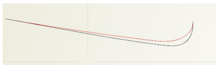
Εικόνα 31: Εξάρτηση της κάτω συνοριακής καμπύλης της κατώτερης επιφάνειας βολβού από μεταβλητές σχεδίασης
