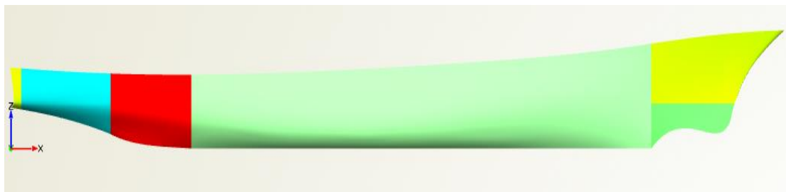
Εικόνα 26: Παραμετρικές επιφάνειες ορισμού της γεωμετρίας
