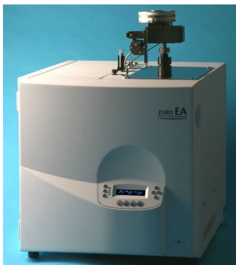
Σχήμα 3-11: Στοιχειακός αναλυτής Euro EA
