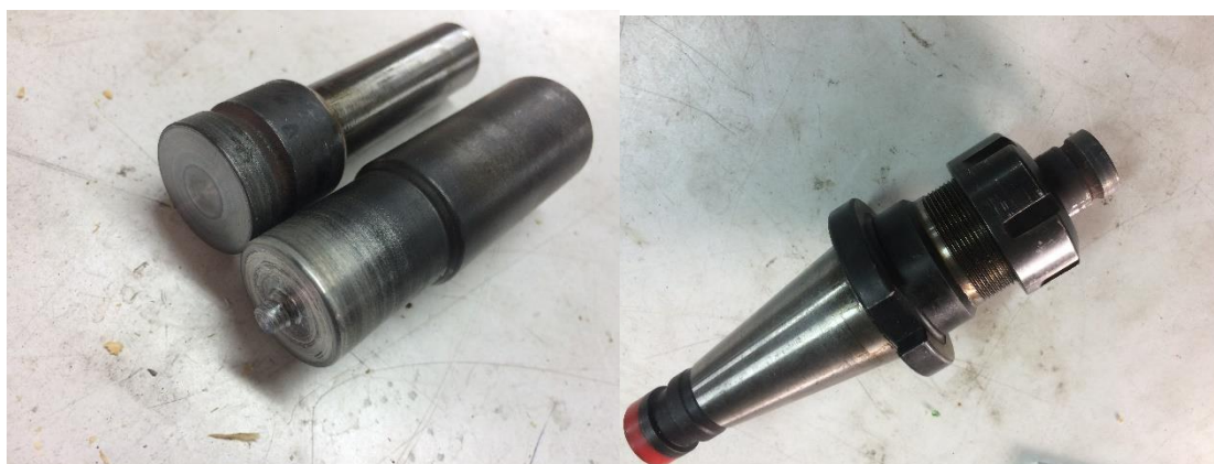
Εικόνα 2.4.3 - Κεφαλές κατεργασίας FSP (αριστερά) και αντάπτορας (δεξιά) για την προσαρμογή τους στην φρέζα.
