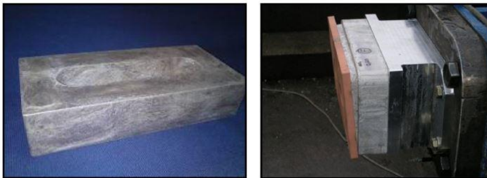
Εικόνα 1.4.6.4 - Υλικά τύπου "Alporas" για την απορρόφηση ενέργειας σε τρένα.
