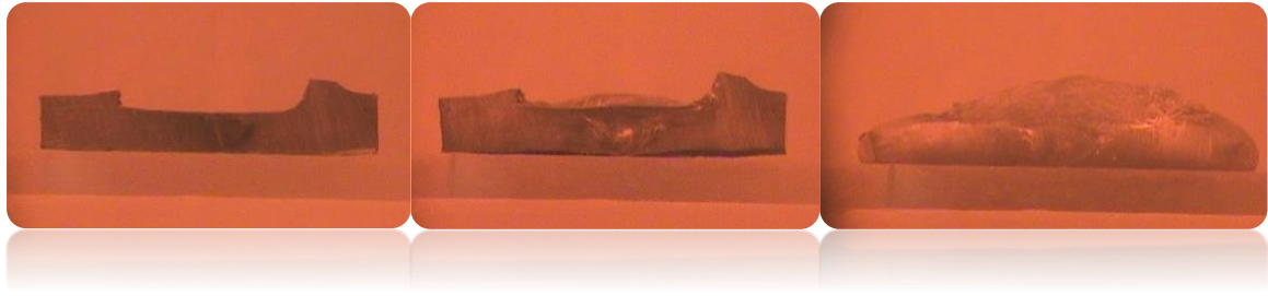
Εικόνα 2.5.11 - Στάδια αφροποίησης δοκιμίου A10.
