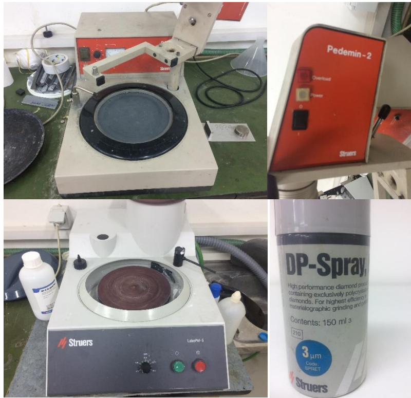
Εικόνα 2.4.6 - Εργαλεία λείανσης (επάνω) και στίλβωσης (κάτω).
