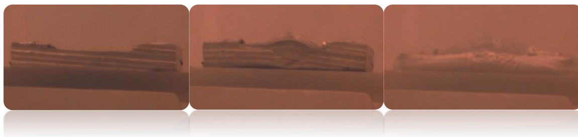
Εικόνα 2.5.23 - Στάδια αφροποίησης δοκιμίου B8.
