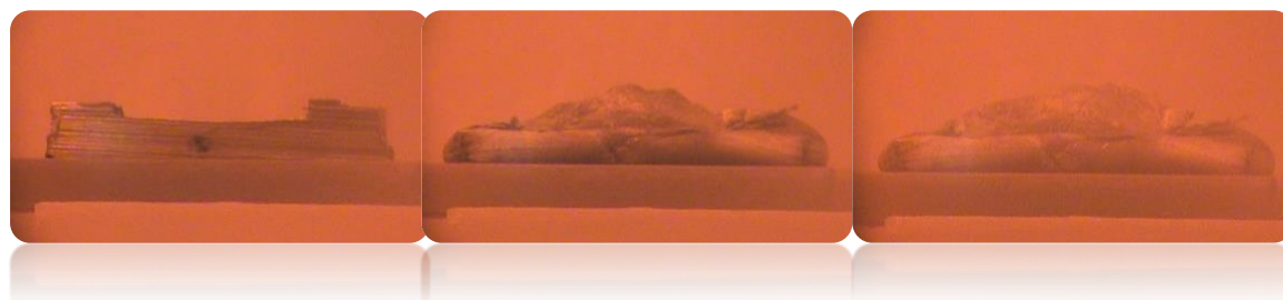
Εικόνα 2.5.9 - Στάδια αφροποίησης δοκιμίου A8.
