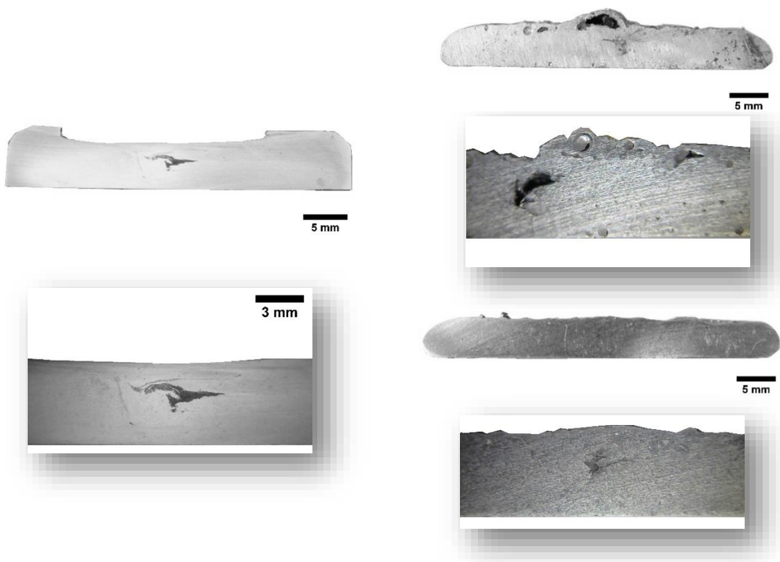
Εικόνα 2.5.5 - Πρόδρομο και αφροποιημένα δοκίμια τριών περασμάτων.
