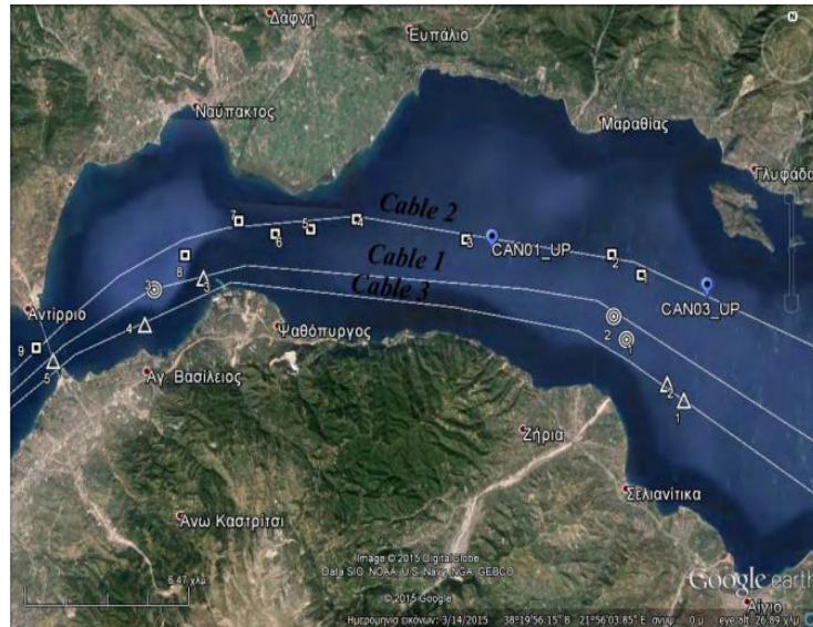
Εικόνα 187: Υποθαλάσσια Καλώδια στον Κορινθιακό Κόλπο και οι θραύσεις που έχουν σημειωθεί. Πηγή: Σεργίου Σπυρίδων, Σύγχρονες Διεργασίες Ιζηματογένεσης στο Δυτικό Κορινθιακό Κόλπο, Εργαστήριο Θαλάσσιας Γεωλογίας και Φυσικής Ωκεανογραφίας, Πανεπιστήμιο Πατρών
