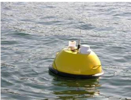
Εικόνα 1.3: Πλωτήρας τρισδιάστατης καταγραφής κυματισμών
