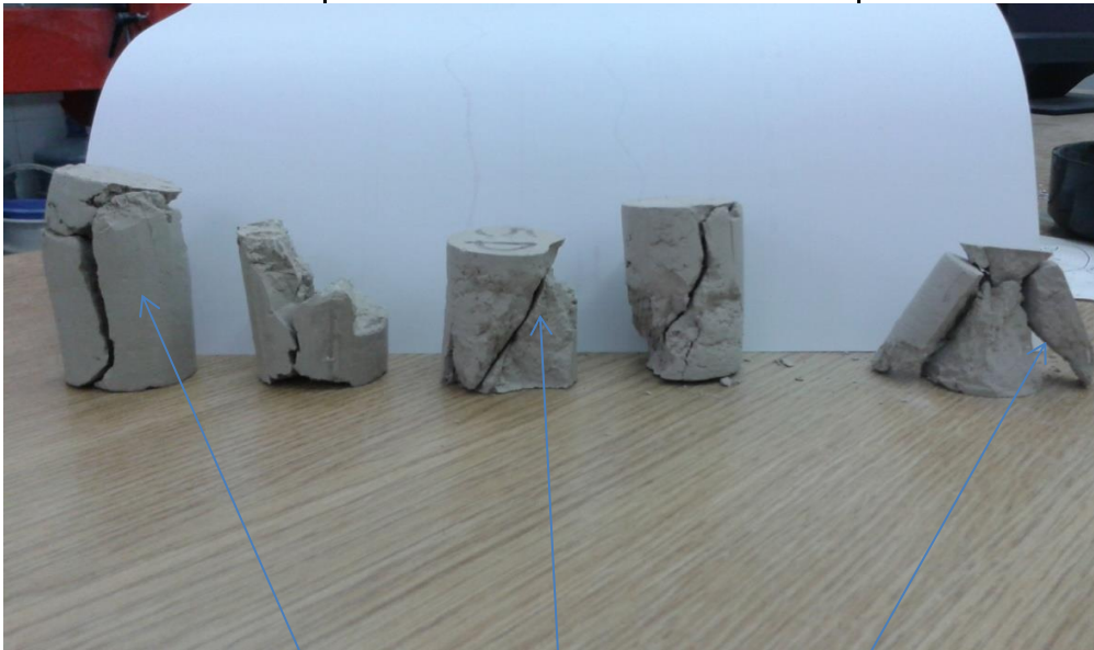
Σχήμα 3. 24 αποτελέσματα θραύσης με διαφορετικό τρόπο στοίβαξης
