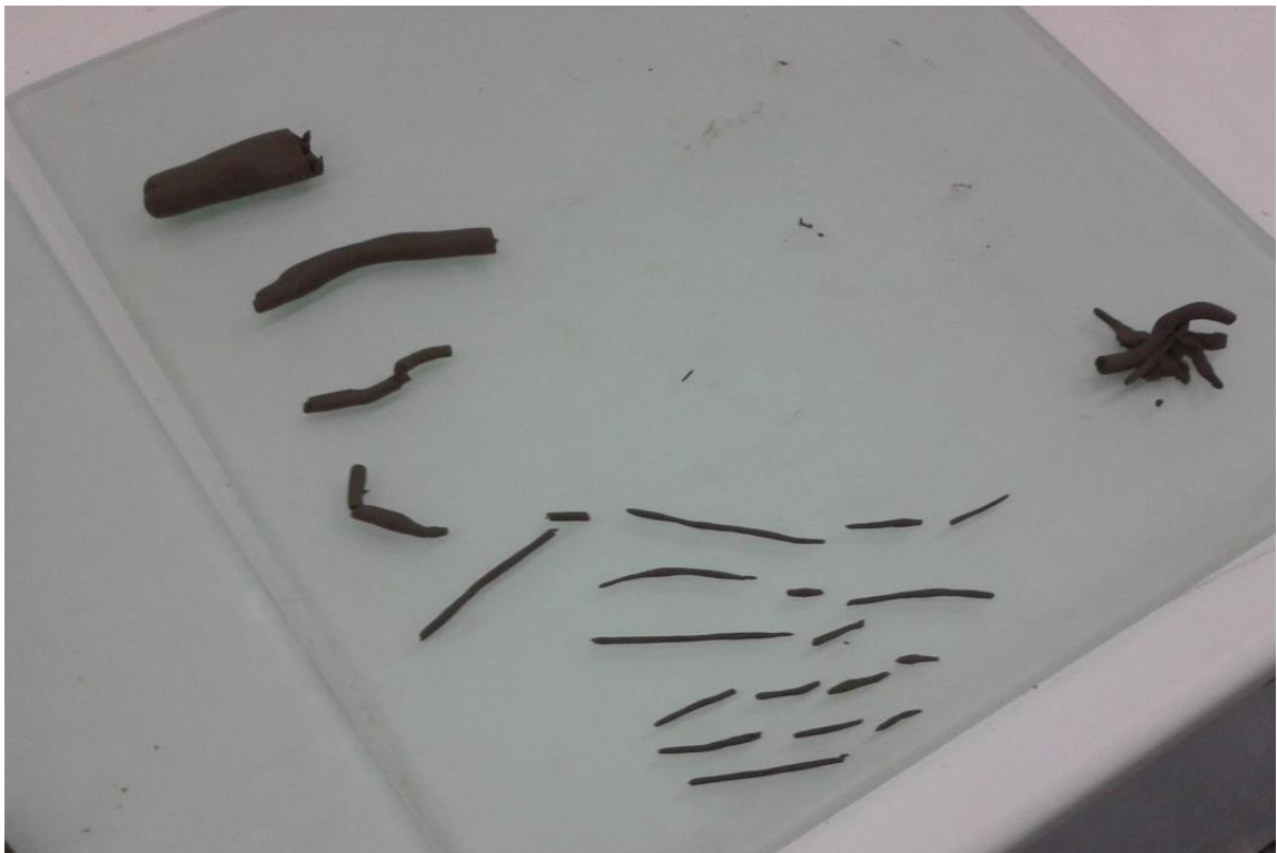
Σχήμα 2. 11 Προσδιορισμός ορίου πλαστικότητας-πλασιμότητας
