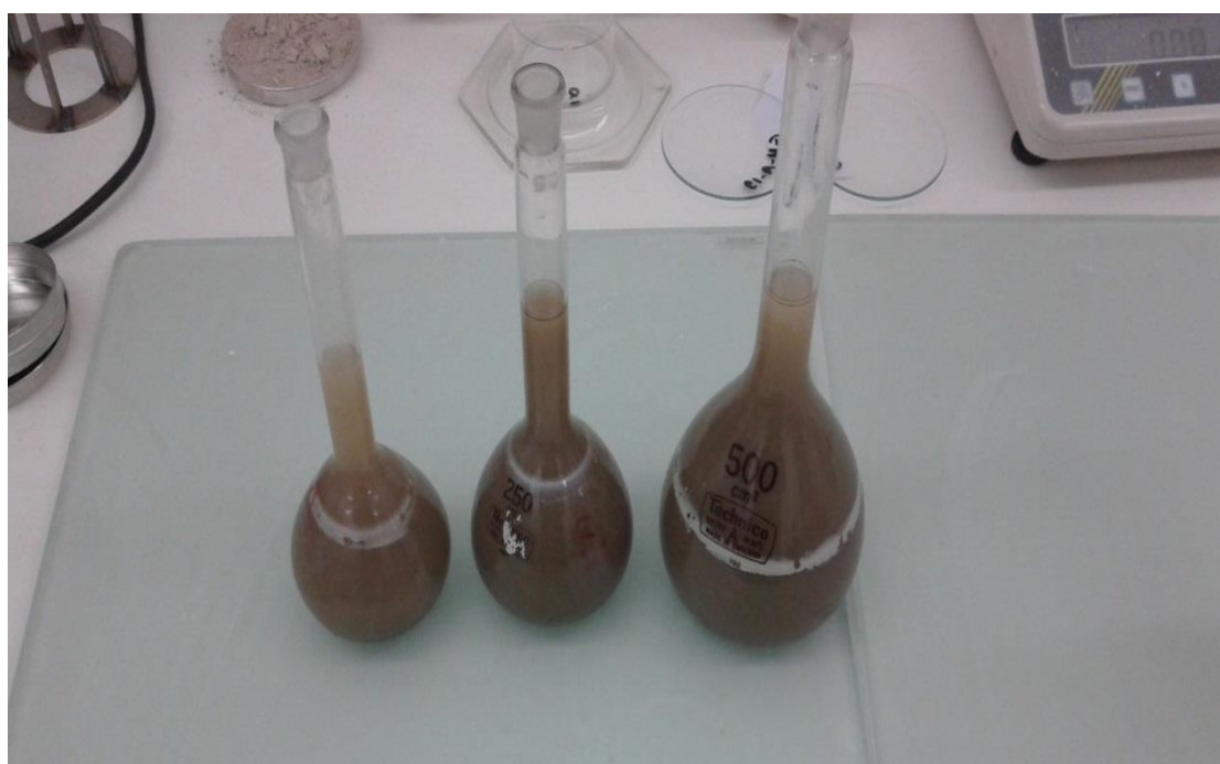
Σχήμα 2.19 Φωτογραφία διαδικασίας προσδιορισμού ειδικής βαρύτητας Ατταπουλίτη
