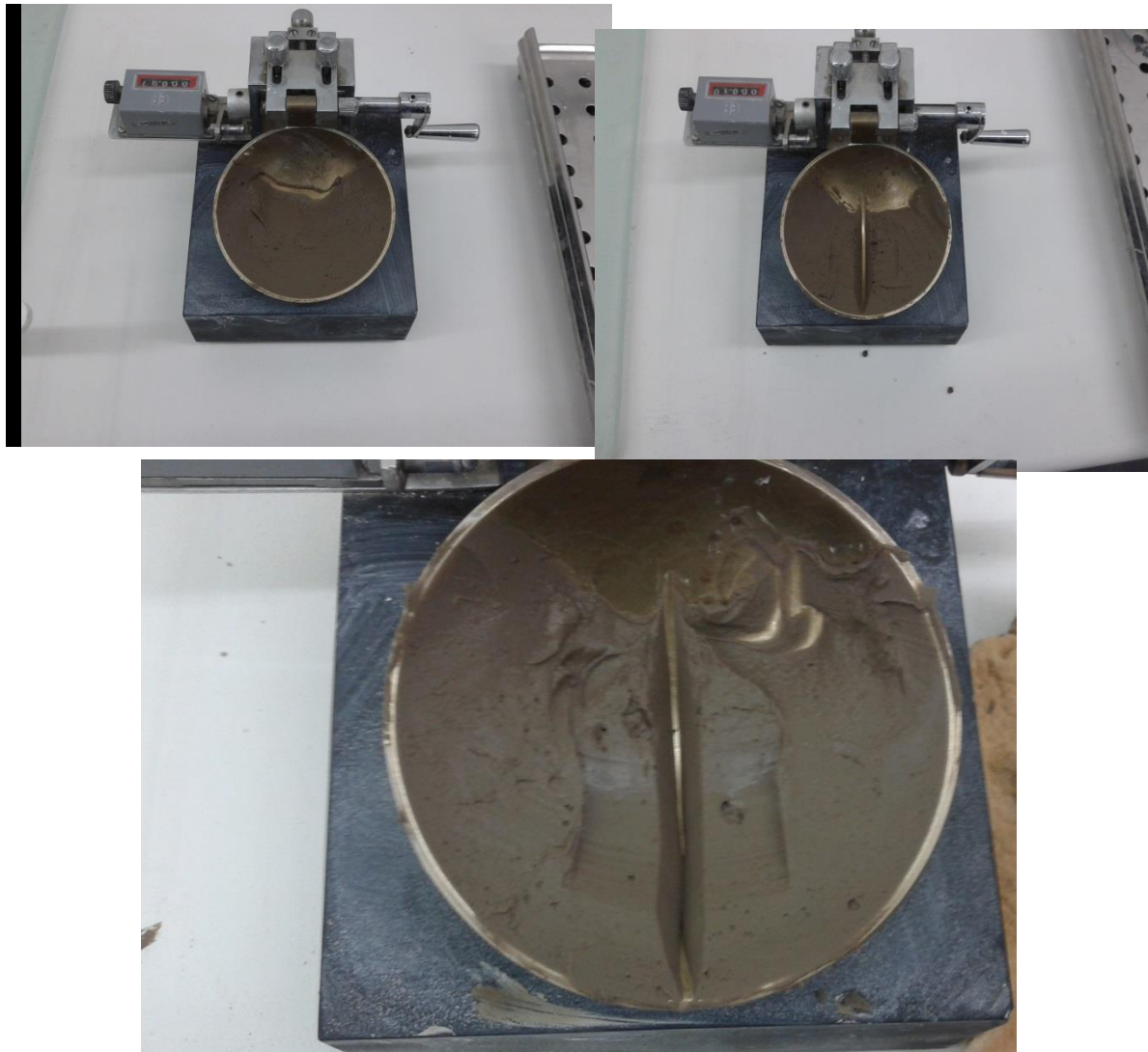
Σχήμα 2. 10 Διαδικασία εκτίμησης ορίου υδαρότητας με χρήση συσκευής Casagrande
