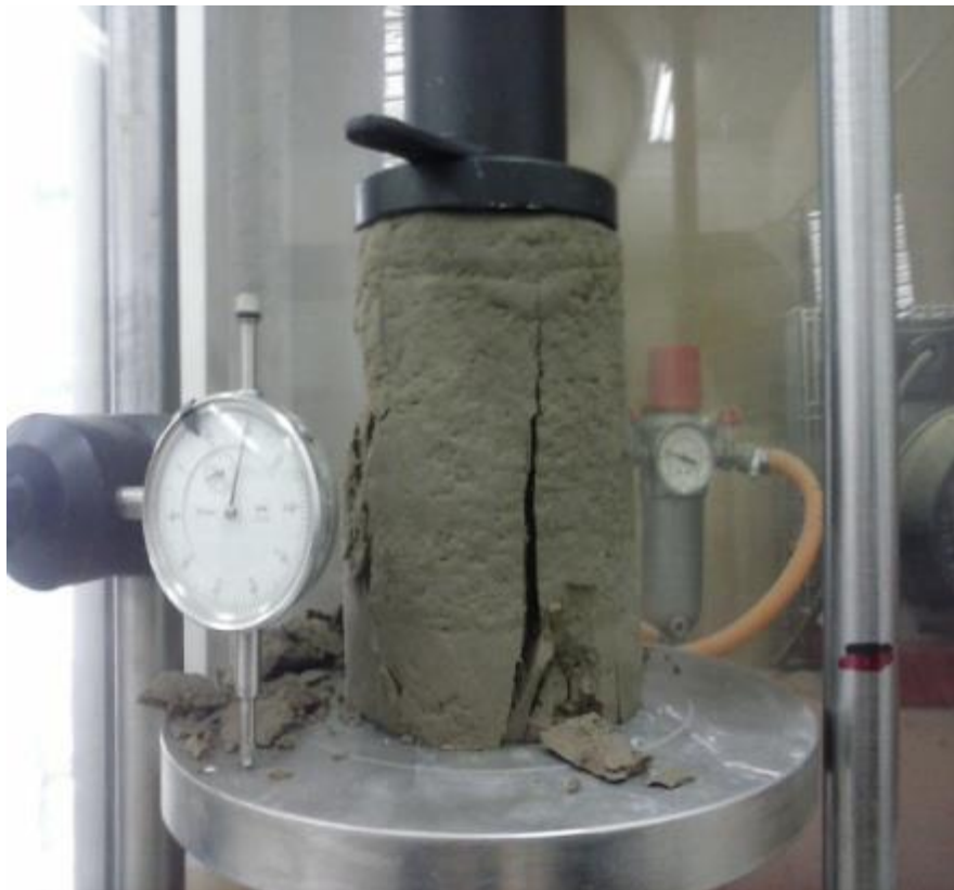
Σχήμα 3. 23 δοκίμιο Ατταπουλγίτη με εφελκυστική θραύση σε δοκίμιο διαμέτρου 101.92 mm
