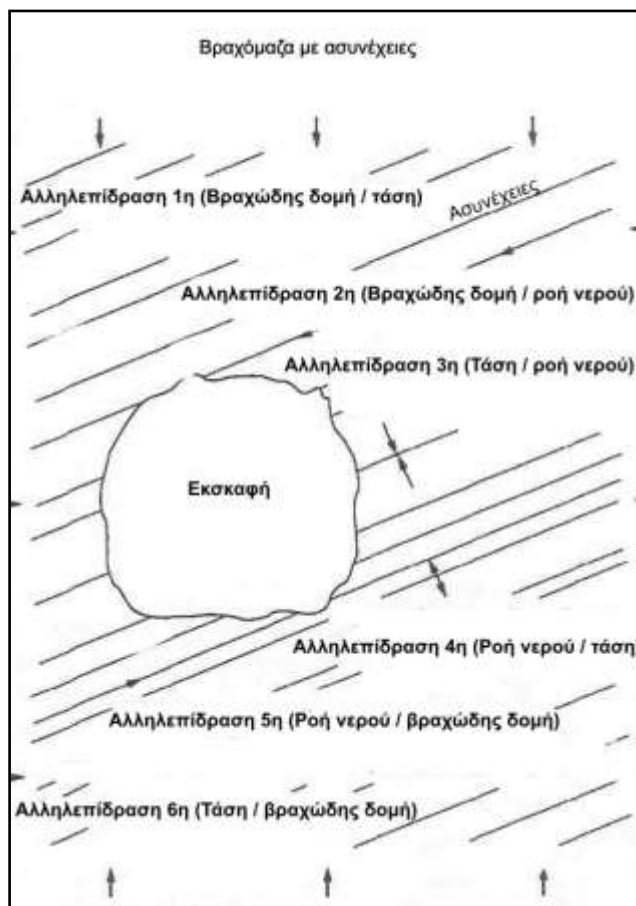
Σχήμα 3.3. Παρουσίαση έξι αλληλεπιδράσεων ανάμεσα στη βραχώδη δομή, την τάση και την ροή του νερού σε περιβάλλον μιας υπόγειας εκσκαφής (Hudson, 1992).
