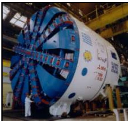
Εικόνα 3.3. Άποψη από μηχάνημα ολομέτωπης προσβολής (Μαρίνος, 2005).
