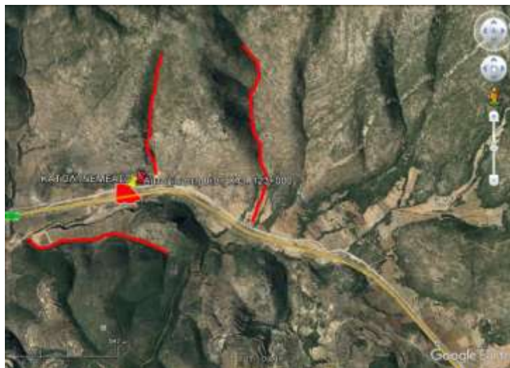
Εικόνα 5.16. Άποψη της θέσης της αστοχίας. Με κόκκινη γραμμή, η απεικόνιση τεκτονικών ασυνεχειών.
