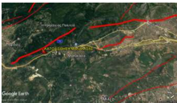
Εικόνα 5.8. Η ρηξιγενής ζώνη Σφενδάλης (περίπου τρία χιλιόμετρα βόρεια της αστοχίας στη Χ.Θ. 36+000) – Αυλώνας. Η απεικόνιση των ενεργών ρηγμάτων (με κόκκινο χρώμα) έχει ληφθεί από τους Ganas et al. (2013).
