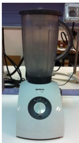
Εικόνα 3-3: Μπλέντερ ομογενοποίησης πρωτοβάθμιας ιλύος
