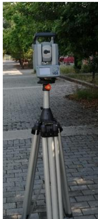
Εικόνα 2.2-2.3: Ανακλαστήρας και ΟΓΣ πάνω στο βιομηχανικό τρίποδα
