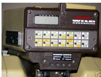
Εικόνα 1.5 : Το αποστασιόμετρο Wild DIOR 3002S. Η πρώτη διάταξη με δυνατότητα μέτρησης χωρίς ανακλαστήρα[ www.bujorel.com/id2.html ]
