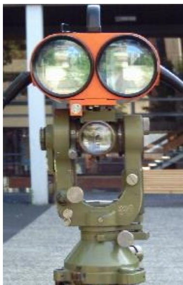
Εικόνα 1.1: Το DistomatDI 10 [ www.vermessungsseiten.de/html ]
