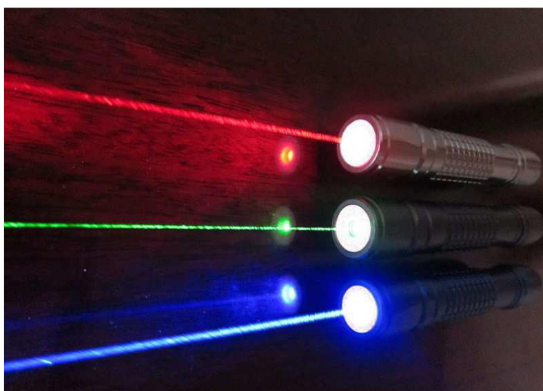
Εικόνα 1.6: Κόκκινο (635nm), πράσινο(532nm) και μπλε (445nm) laser [Wikipedia.org]
