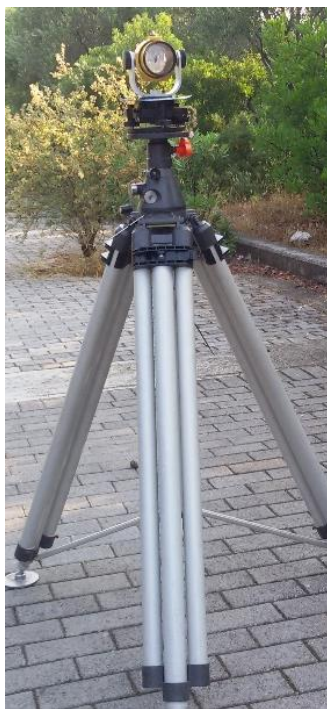
Εικόνα 2.2-2.3: Ανακλαστήρας και ΟΓΣ πάνω στο βιομηχανικό τρίποδα
