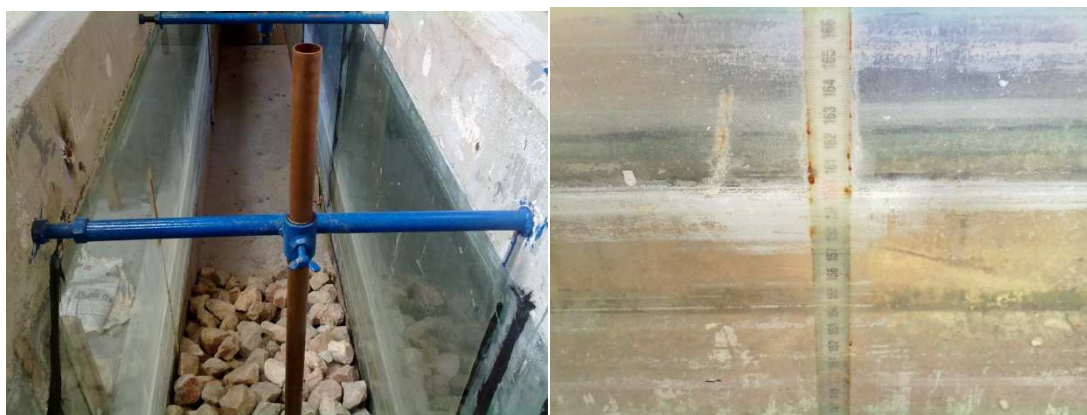
Εικόνα 5.9 Οριζόντιοι υποδοχείς των ανοξειδωτων σωλήνων και βαθμονομημένος γνόμενος για τις οπτικές παρατηρήσεις
