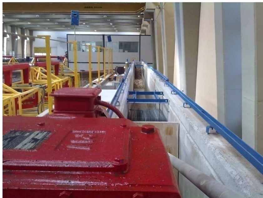
Εικόνα 5.1 Άποψη της πειραματικής διάρυνας από την πλευρά της κυματογεννήτριας.
