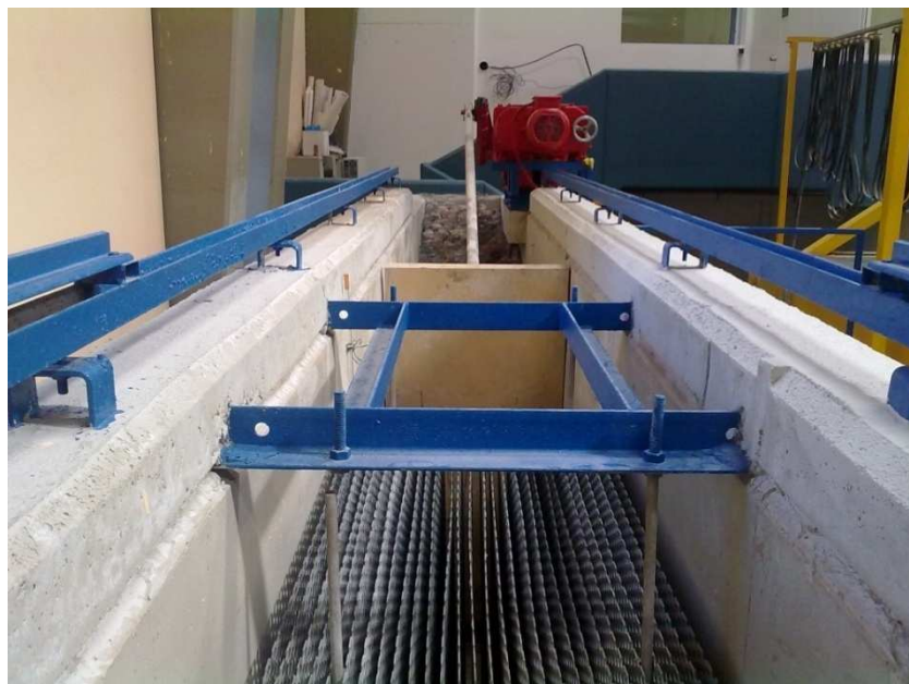
Εικόνα 5.4 Πτερύγιο κυματιστήρα και διάταξη διάτρητων πλακών ομαλοποίησης του κυματισμού
