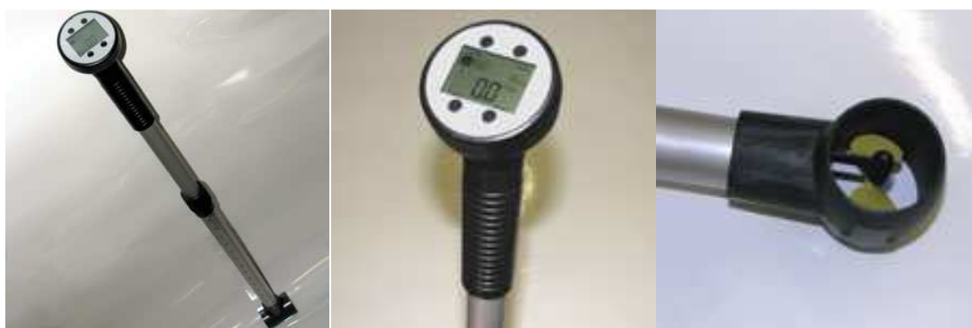
Εικόνα 5.7 Global Water Flow Probe – Η επιστημονική συσκευή που χρησιμοποιήθηκε για τις πειραματικές μετρήσεις στο εξωτερικό της κατασκευής
