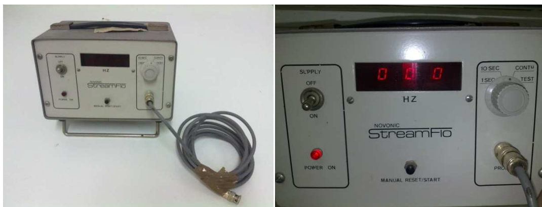
Εικόνα 5.6 Novonic StreamFlo – Η επιστημονική συσκευή που χρησιμοποιήθηκε για τις πειραματικές μετρήσεις στο εσωτερικό της κατασκευής
