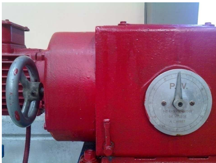
Εικόνα 5.5 Το κιβώτιο ταχυτήτων της κυματογεννήτριας το οποίο καθορίζει τις περιόδους του παραγόμενου κυματισμού
