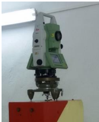
Εικόνα 0-2ικόνα 2.2,2.3: βάση εξαναγκασμένης κέντρωσης και όργανο-διάταξη βάσης εξαναγκασμένης κέντρωσης, τρικόγλιο, βάση στήριξης
