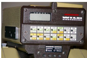
Εικόνα 1.5 : Το αποστασιόμετρο Wild DIOR 3002S. Η πρώτη διάταξη με δυνατότητα μέτρησης χωρίς ανακλαστήρα [ www.bujorel.com/id2.html ]
