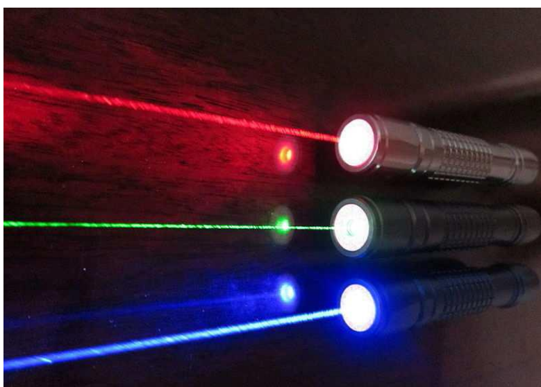
Εικόνα 1.6: Κόκκινο (635nm), πράσινο(532nm) και μπλε (445nm) laser
