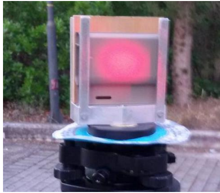
Εικόνα 1.8: Η αύξηση της επιφάνειας αποτυπώματος laser
