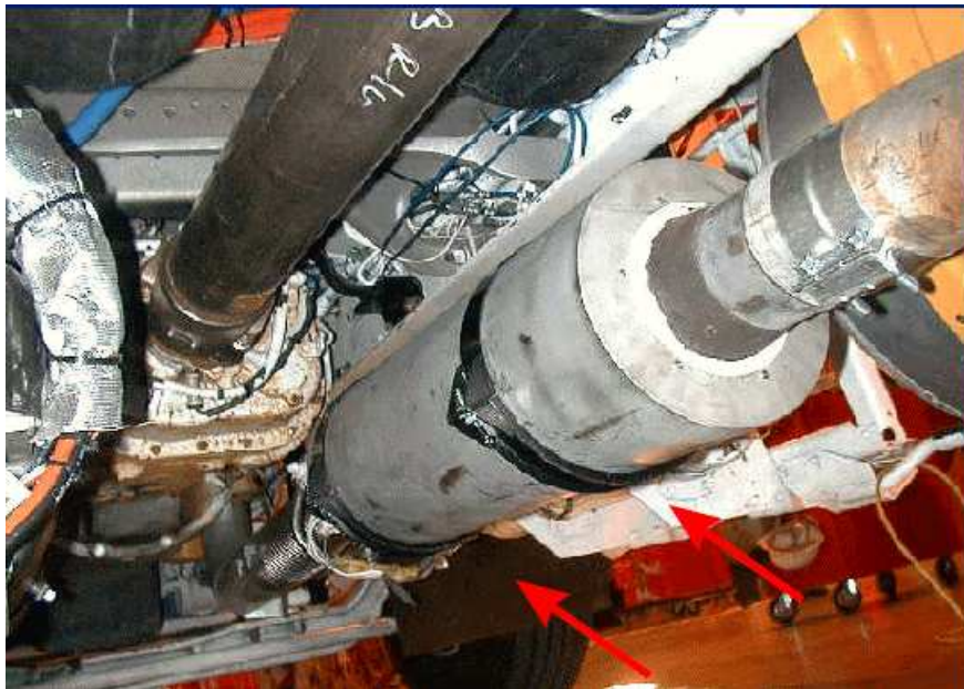
Σχήμα 1-6 Εφαρμογή της Εταιρείας Hi-Z σε Βαρύ Όχημα με Εγκατάσταση Θερμοηλεκτρικής Γεννήτριας για την Ανάκτηση της Θερμότητας του Καυσαερίου.
