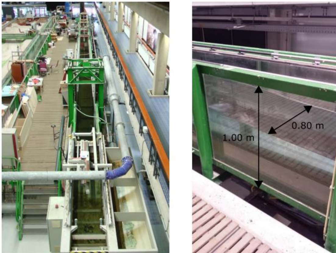
Εικόνα 3.3.1 Γενική άποψη της διώρυγας κυματισμών (αριστερά). Πλάτος και ύψος της διώρυγας (δεξιά).
