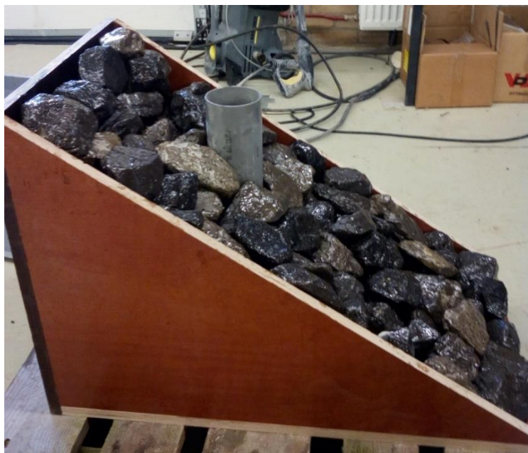
Εικόνα 3.2.1 Πλάγια όψη του πρανούς τριγωνικής διατομής, κλίσης 1:1.5, το οποίο χρησιμοποιήθηκε για την κατασκευή του ύφαλου διαπερατού κυματοθραύστη.
