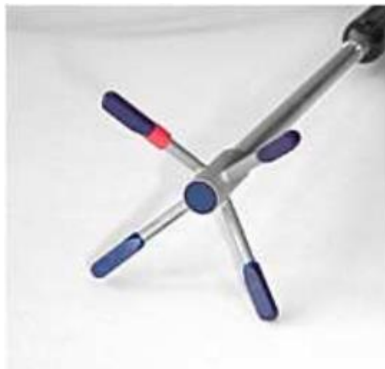
Εικόνα 3.3.8 Το όργανο μέτρησης των ταχυτήτων Vectrino + (πηγή: www.nortek.no ).
