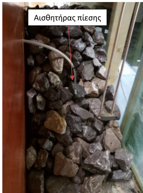
Εικόνα 3.3.5 Θέση του αισθητήρα πίεσης στην προσήνεμη πλευρά του ύφαλου κυματοθραύστη.
