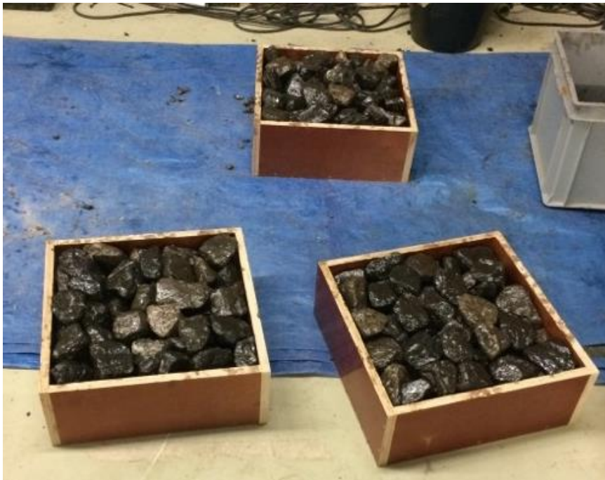
Εικόνα 3.2.3 Οι τρεις ορθογωνικής διατομής πλάκες που χρησιμοποιήθηκαν για την κατασκευή του κεντρικού τμήματος του κυματοθραύστη.
