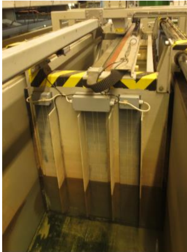
Εικόνα 3.3.2 Η κυματογεννήτρια τύπου εμβόλου εγκατεστημένη στο ανάντη άκρο της διώρυγας κυματισμών.
