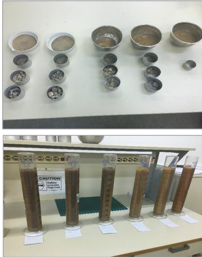
Σχήμα 4.4 Εδαφικά δείγματα στο εργαστήριο μετά το κοσκίνισμα (επάνω) και κατά την εκτέλεση των κοκκομετρικών αναλύσεων με αραιόμετρο (κάτω)
