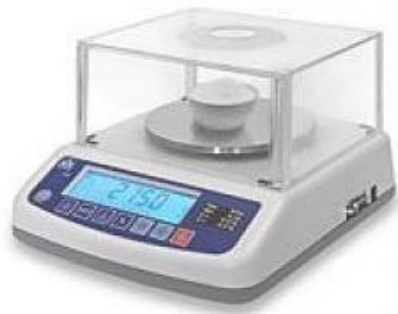
Σχήμα 4.3 Ζυγαριά ακριβείας (αριστερά) και εργαστηριακός φούρνος (δεξιά)
