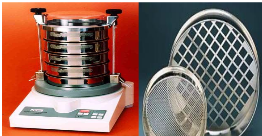
Σχήμα 4.1 Συσκευή κοσκίνισματος (αριστερά ) και κόσκινα (δεξιά)
