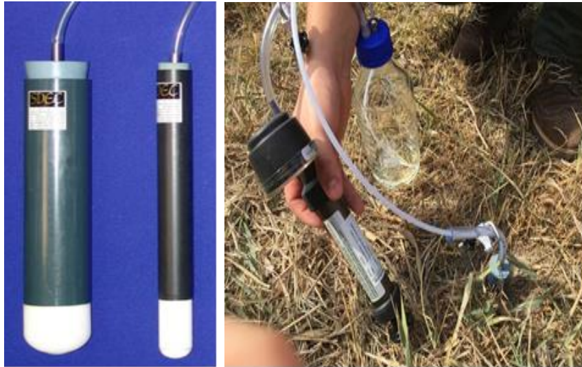
Σχήμα 3.3 Σύστημα λυσιμέτρων αναρρόφησης αποτελούμενο από το κάτω τμήμα εισαγωγής με κεραμική πορώδη κεφαλή (αριστερά) και ανω μέρος με μονάδα δειγματοληψίας (δεξιά)
