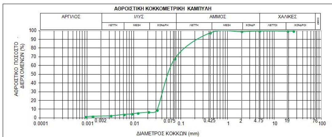
Σχήμα 4.5 Κοκκομετρική καμπύλη δείγματος στη θέση Ο (0-0.5m)
