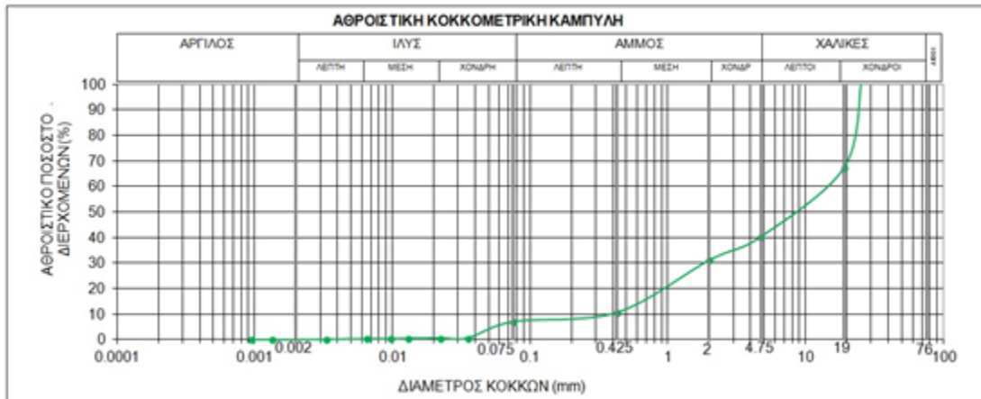
Σχήμα 4.8 Κοκκομετρική καμπύλη δείγματος στη θέση Ο (1.5- 2 m)
