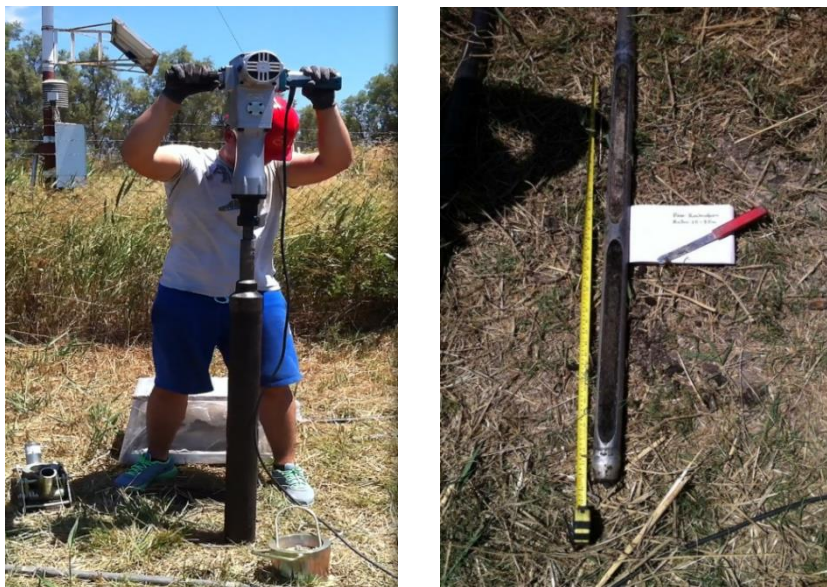
Σχήμα 3.2 Διαδικασία διάνοιξης γεώτρησης ( αριστερά) και δειγματολήπτης (δεξιά)
