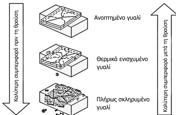
Εικόνα 3.1. Συμπεριφορά των τριών προϊόντων γυαλιού σε πολυστρωματική διάταξη
