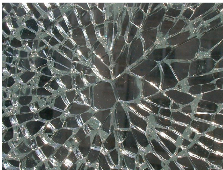
Εικόνα 2.7. Ακαριαία θραύση σκληρωμένου γυαλιού εξαιτίας της παρουσίας κρυστάλλων θειούχου νικελίου (NiS)
