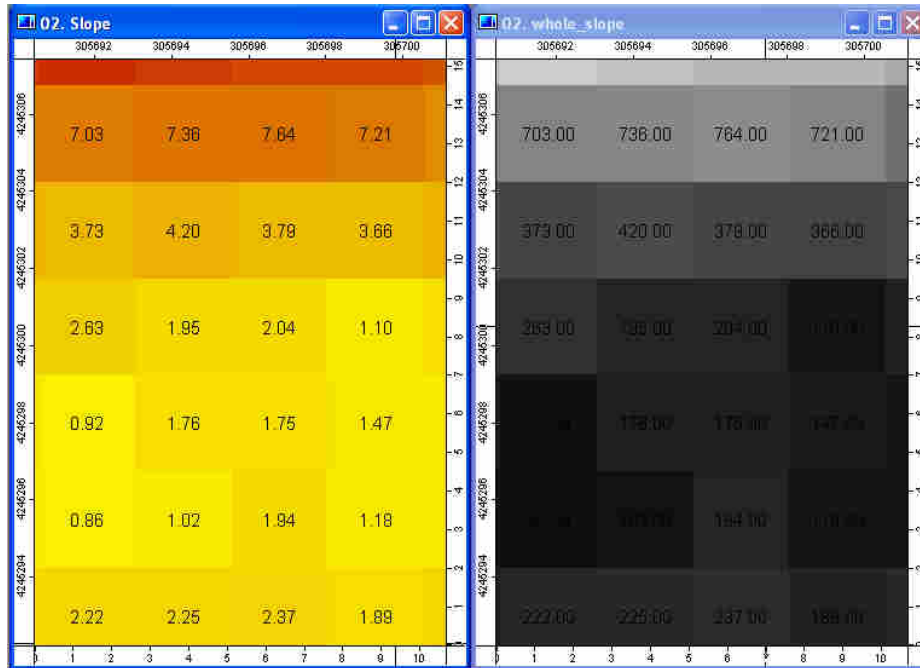
Εικόνα 54 Τμήμα του slope-gradient πριν και μετά την εφαρμογή των modules: Grid Calculator. Αριστερά εμφανίζεται η απεικόνιση slope-gradient όπως ακριβώς είναι αμέσως μετά την εφαρμογή του module υπολογισμού της κλίσης ενώ δεξιά είναι το τελικό εξαγόμενο img. Παραχώρηση DEM: akti engineering
