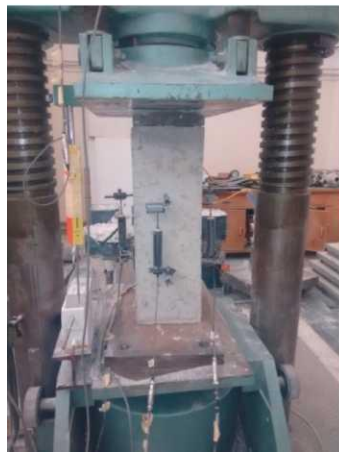
Σχήμα 3.11: Τοποθέτηση στη διάταξη φόρτισης του δοκιμίου και αστοχία υπό μορφή διαμήκους διάρρηξης: α) Δοκίμιο ΑΠ1 15x15cm 2 και β) Δοκίμιο ΑΠ3 25x25cm 2
