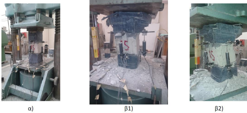
Σχήμα 3.41: Δοκίμιο Π15. α) Το δοκίμιο στη μηχανή θλίψης πριν την έναρξη δοκιμής, β1) Το δοκίμιο κατά τη διάρκεια του πειράματος στην αποφλοιώση και β2) μετά το πέρας του πειράματος.
