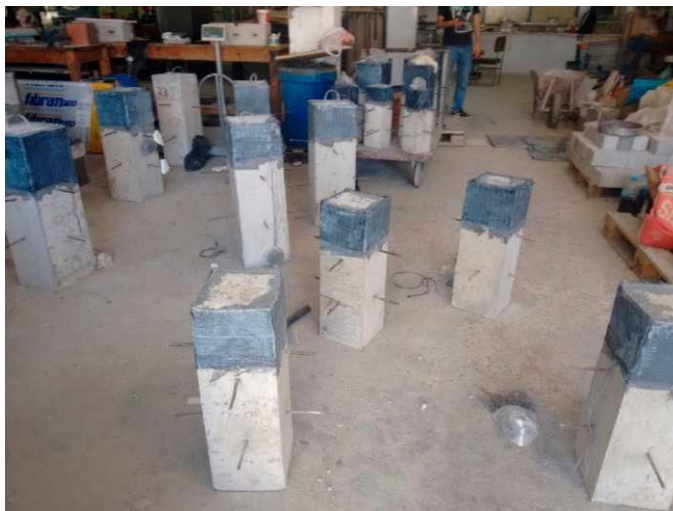
Σχήμα 3.5: Τα ολοκληρωμένα δοκίμια στο δάπεδο του ΕΟΣ ΕΜΠ πριν τις δοκιμές
