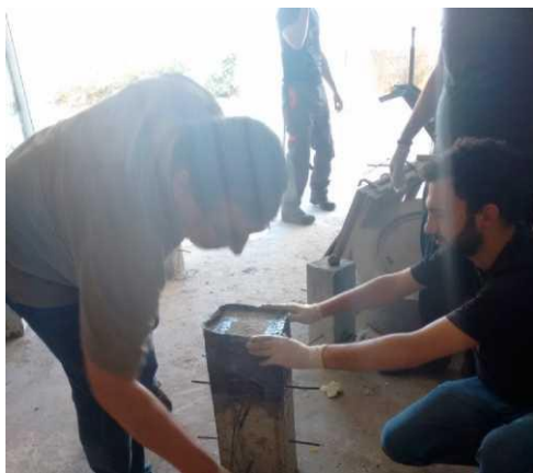
Σχήμα 3.3: Ενίσχυση των δοκιμίων στα άκρα. α) Διαδικασία επικόλλησης των ρητινών και β) Τυπικό ενισχυμένο δοκίμιο
