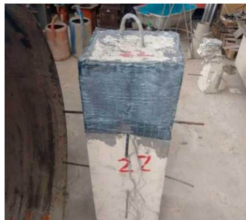
Σχήμα 3.3: Ενίσχυση των δοκιμίων στα άκρα. α) Διαδικασία επικόλλησης των ρητινών και β) Τυπικό ενισχυμένο δοκίμιο
