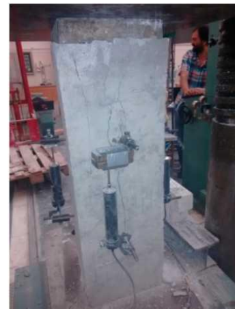
Σχήμα 3.11: Τοποθέτηση στη διάταξη φόρτισης του δοκιμίου και αστοχία υπό μορφή διαμήκους διάρρηξης: α) Δοκίμιο ΑΠ1 15x15cm 2 και β) Δοκίμιο ΑΠ3 25x25cm 2
