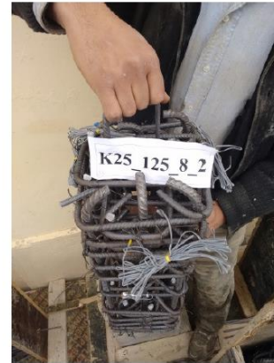
Σχήμα 3.44: Δοκίμιο Π17. α) Διάταξη όπλισης στο μεσαίο τμήμα ελέγχου και στα ενισχυμένα άκρα, β) Κλωβός όπλισης του δοκιμίου.
