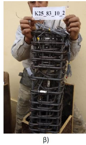
Σχήμα 3.54: Δοκίμιο Π22 α) Διάταξη όπλισης στο μεσαίο τμήμα ελέγχου και στα ενισχυμένα άκρα, β) Κλωβός όπλισης του δοκιμίου
