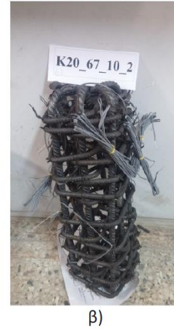
Σχήμα 3.34: Δοκίμιο Π12. α) Διάταξη όπλισης στο μεσαίο τμήμα ελέγχου και στα ενισχυμένα άκρα, β) Κλωβός όπλισης του δοκιμίου.
