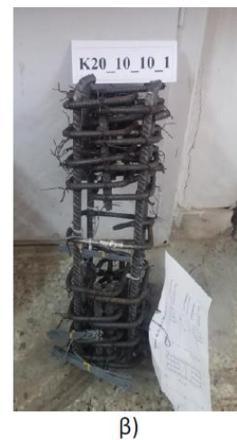
Σχήμα 3.21: Δοκίμιο Π5. α) Διάταξη όπλισης στο μεσαίο τμήμα ελέγχου και στα ενισχυμένα άκρα, β) Κλωβός όπλισης του δοκιμίου
