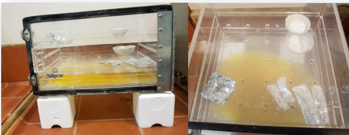
Σχήμα 3.8: Ξηραντήρας τοποθέτησης των φίλτρων για την μέτρηση των στερεών
