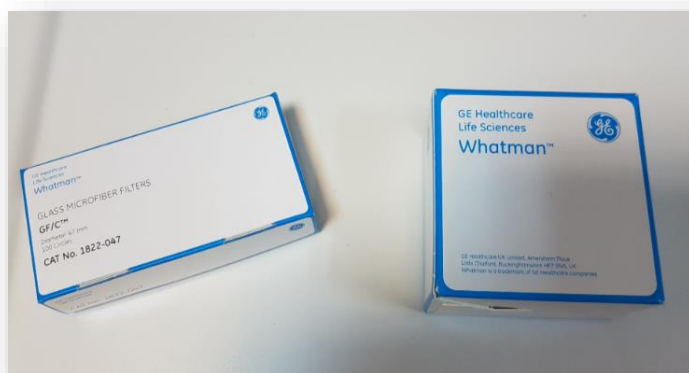
Σχήμα 3.7: Φίλτρα GF/C της Whatman με μέγεθος πόρων 1,2 μm (αριστερά) και μεμβράνες Whatman με μέγεθος πόρων 0,45 μm (δεξιά)
