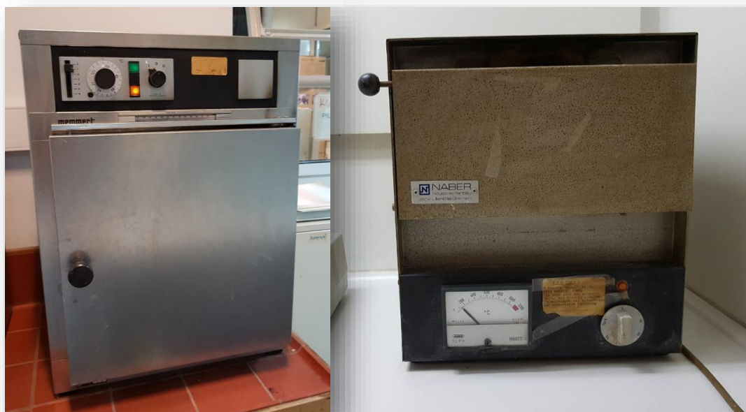
Σχήμα 3.9: Φούρνος 105 °C (αριστερά) και φούρνος 550 °C για τον προσδιορισμό των TSS και VSS
