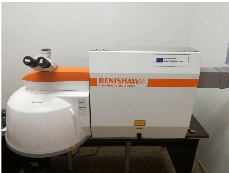
Εικόνα 2.26: Όργανο φασματοσκοπίας Raman inVia Raman Microscope της εταιρίας Renishaw
