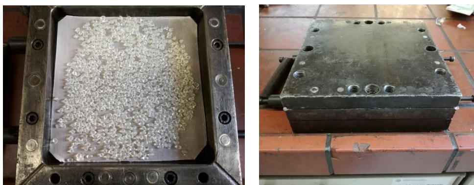
Εικόνα 2.2: Pellets εντός του καλουπιού μορφοποίησης (αριστερά), κλειστό καλούπι μετά τη μορφοποίηση (δεξιά)
