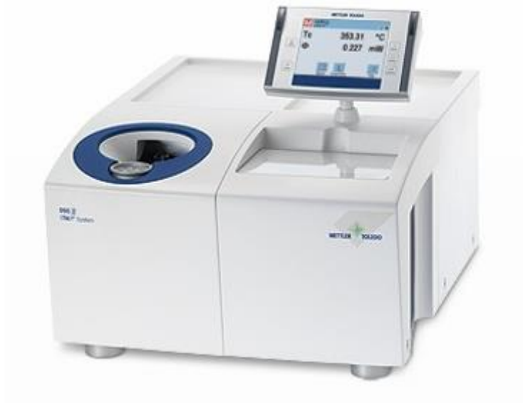
Εικόνα 2.17: Το όργανο Mettler DSC 1 STARe System που χρησιμοποιήθηκε για τις DSC αναλύσεις.
