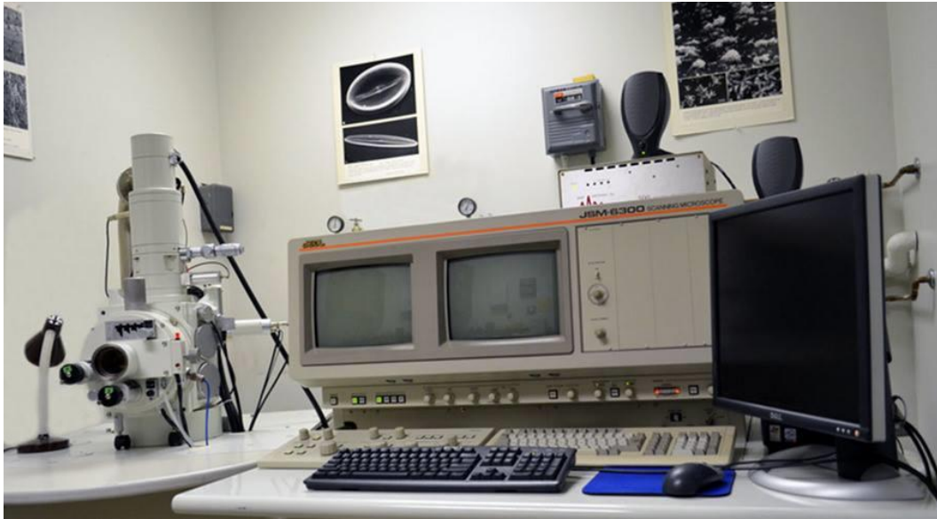
Εικόνα 2.29: Ηλεκτρονικό μικροσκόπιο SEM JSM 6300 της Jeol
