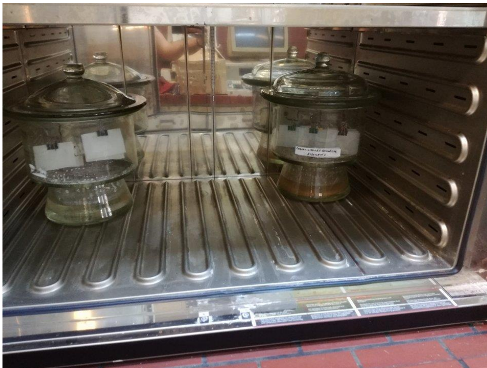
Εικόνα 2.4: Ξηραντήρες με δείγματα προς υδρόλυση εντός φούρνου
