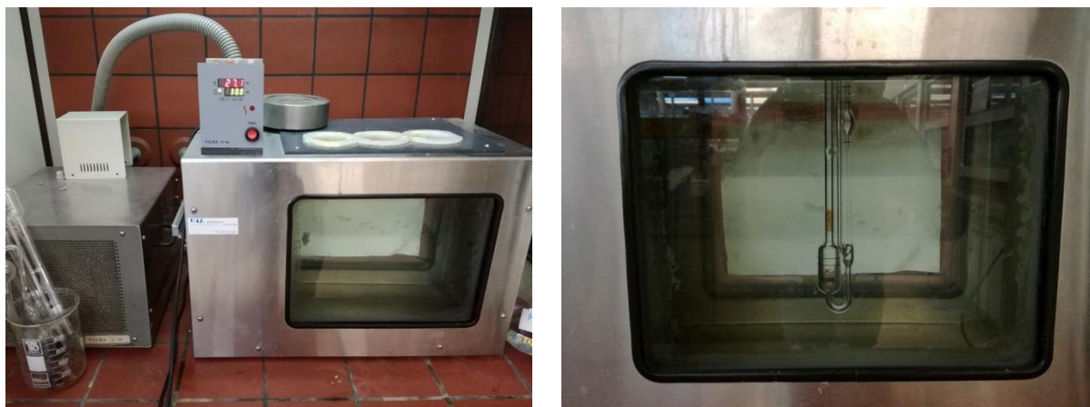
Εικόνα 2.7: Διάταξη υδατόλουτρου ελεγχόμενης θερμοκρασίας (αριστερά), ιξωδόμετρο εντός υδατόλουτρου (δεξιά)
