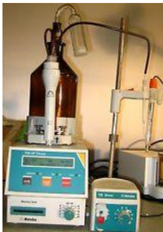
Εικόνα 2.8: Ο αυτόματος τιτλοδότης 716 DMS Titrino της εταιρείας METROHM, που χρησιμοποιήθηκε για τον προσδιορισμό της συγκέντρωσης των ακραιών ομάδων.
