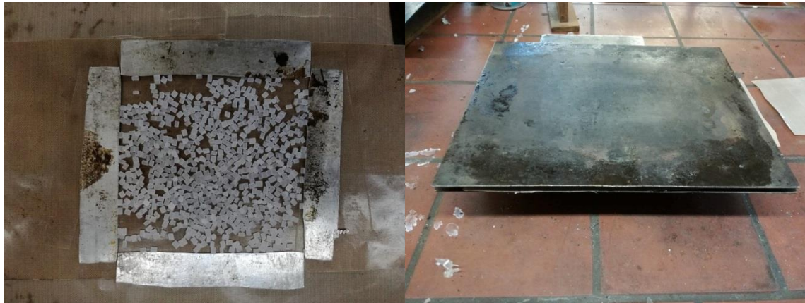
Εικόνα 4.1: Pellets πολύ(γαλακτικού οξέος) πριν την θερμική επεξεργασία εντός μεταλλικών αγωγών (αριστερά), κλειστό καλούπι μετά την θερμική επεξεργασία (δεξιά)
