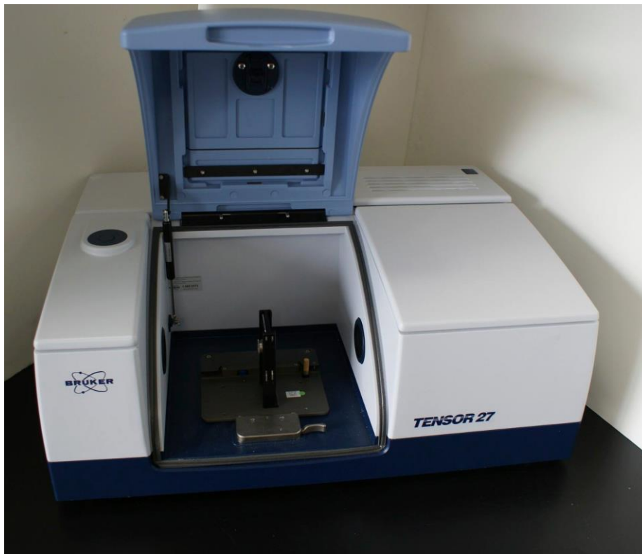
Εικόνα 2.24: Όργανο FTIR Tensor 27 της εταιρίας Bruker
