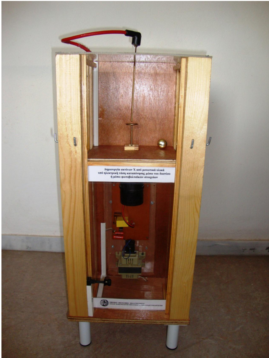
Σχήμα 3.2: Η διάταξη εκπομπής ηλεκτρομαγνητικής ακτινοβολίας
