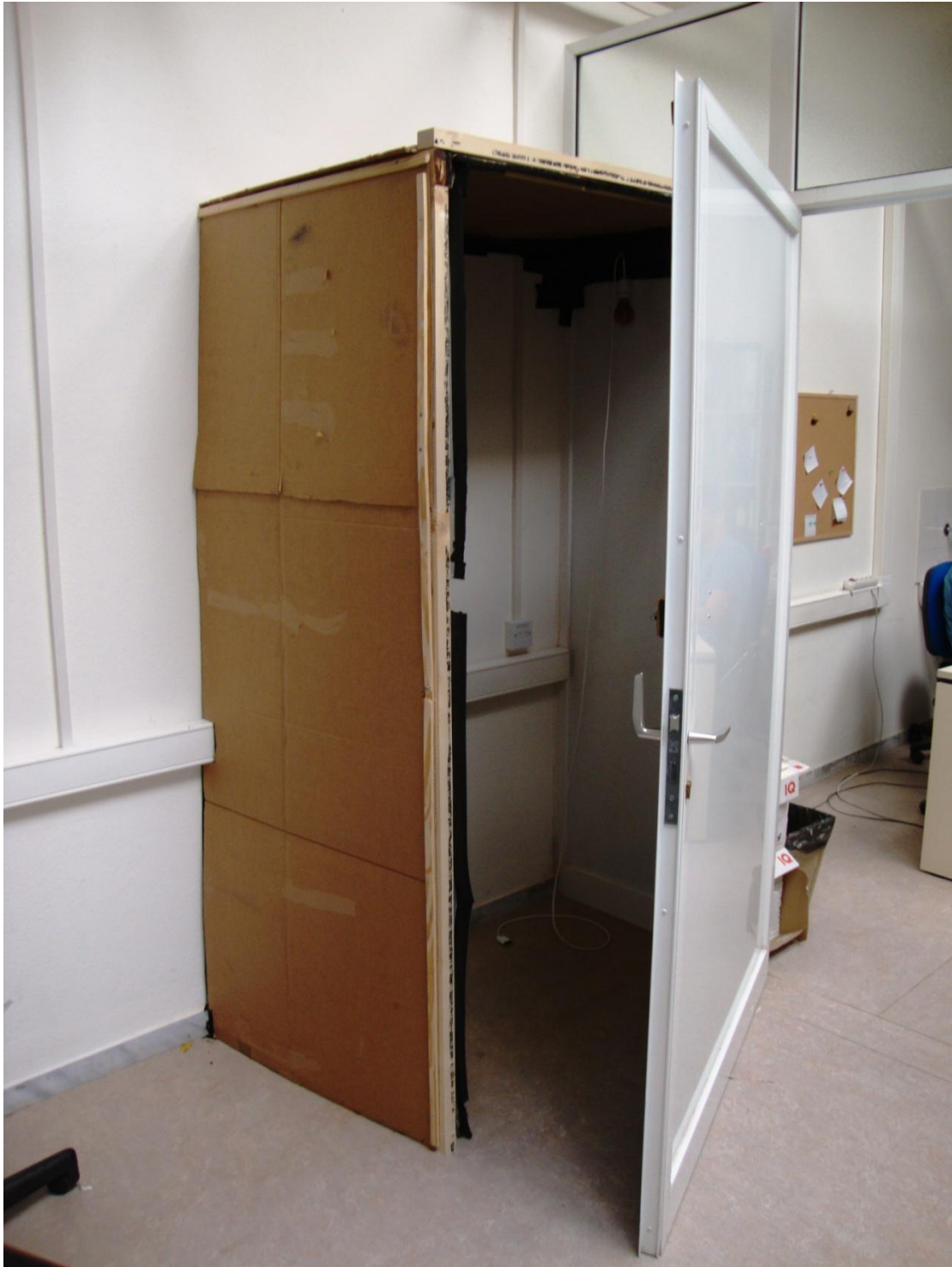
Σχήμα 4.5: Ο σκοτεινός θάλαμος μου κατασκευάστηκε για την εμφάνιση του φωτογραφικού φιλμ
