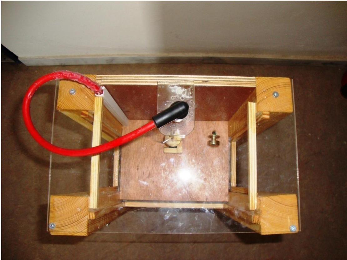
Σχήμα 3.4: Το ηλεκτρόδιο ακίδα-πλάκα της διάταξης
