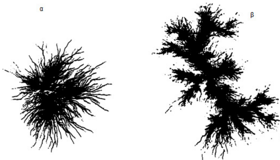
Σχήμα 1.4.3.4-5: Φωτογραφίες δενδριτών κατά την καταπόνηση πολυμερών στερεών μονωτικών στον αέρα, υπό κρουστική τάση 1,2/50μs (διάταξη ηλεκτροδίων: ακίδα- πλάκα) α) Δενδρίτης σε τιμές πεδίου πλησίον της περιοχής τιμών για την επιφανειακή διάσπαση β) Δενδρίτης κατά την επιφανειακή διάσπαση
