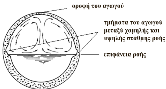
Σχήμα 3.5 Η άνιση κατανομή της διάβρωσης στα τοιχώματα αγωγού από σκυρόδεμα (U.S.E.P.A., 1974).
