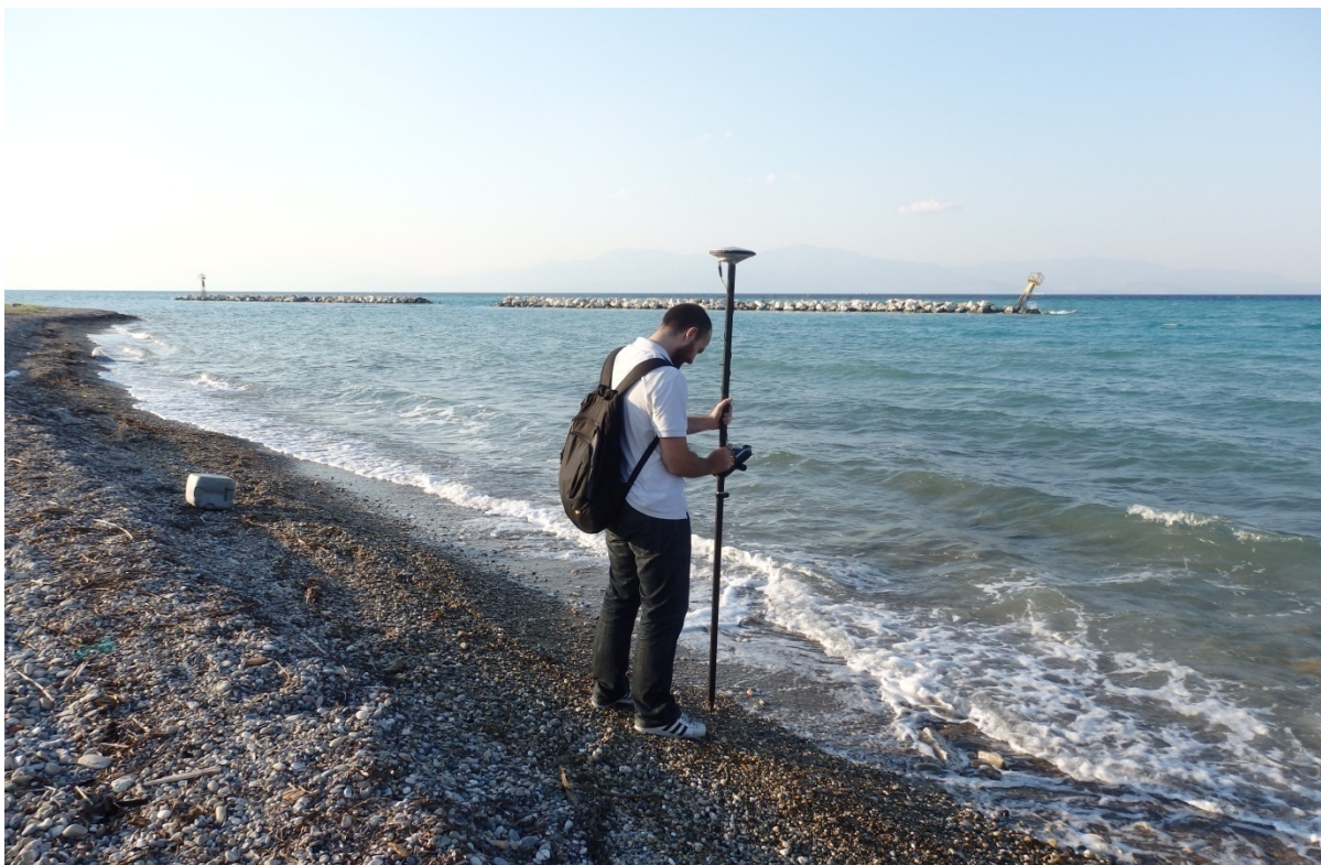
Σχήμα 4.9. Αποτύπωση της ακτογραμμής με τη χρήση τοπογραφικού GPS.
