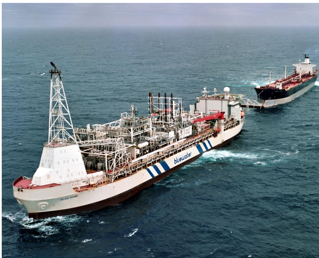
Σχήμα 16: Πλωτή μονάδα παραγωγής, αποθήκευσης και εκφόρτωσης πετρελαίου και φυσικού αερίου (FPSO)
