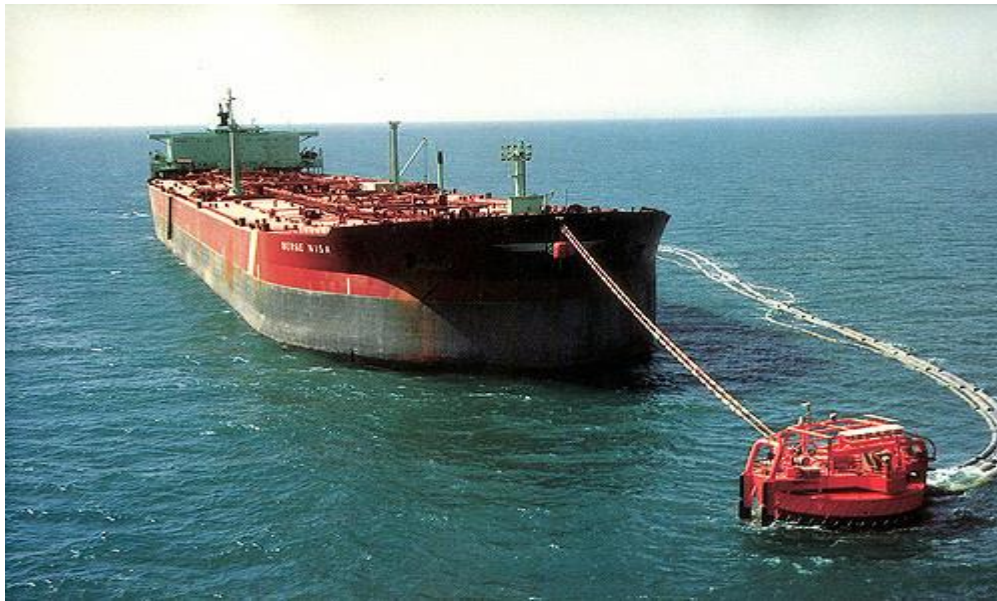
Σχήμα 19: Πλατφόρμα με μορφή σημαδούρας (CALM)
