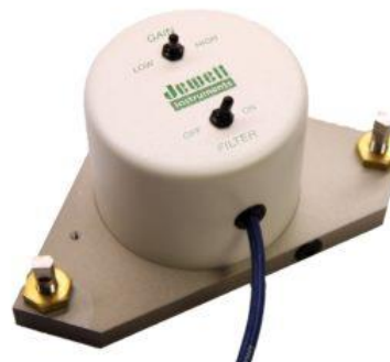
(β) Μορφή ηλεκτρολυτικού κλισίμετρου
