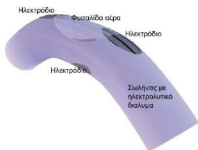
(α) Αρχές ηλεκτρολυτικού κλισίμετρου
