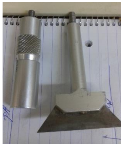
Εικόνα 20: Κύλινδρος συμπίεσης και λεπίδα κοπής
