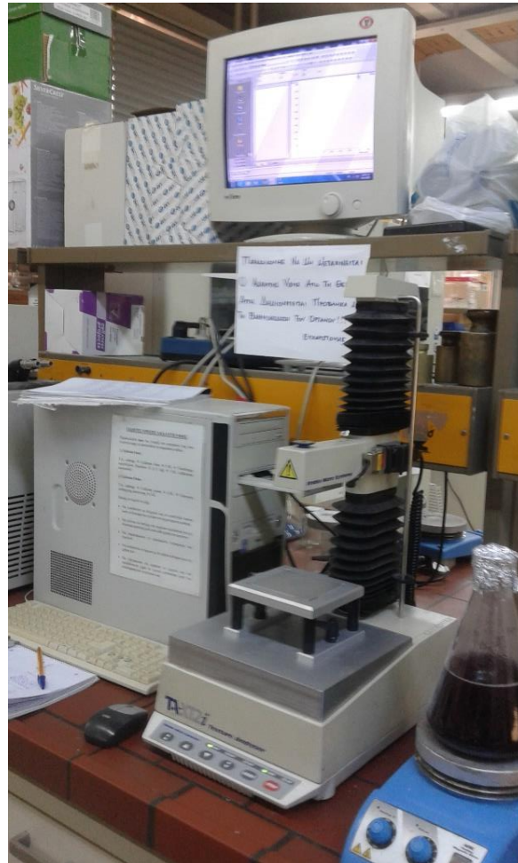
Εικόνα 19: Αναλυτής υφής TA-XT2
