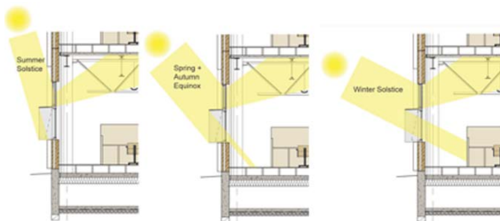
Σχήμα 2.14 Ράφια ανάκλασης φωτός (light shelves) [30]
