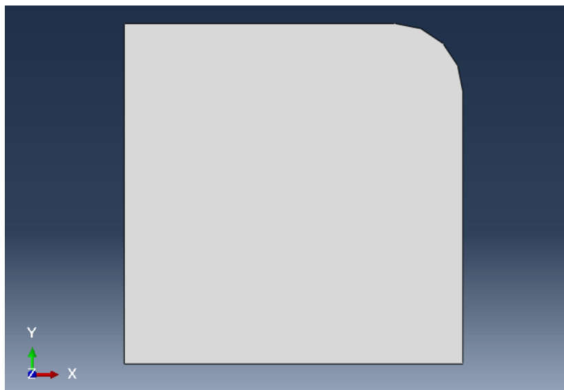
Εικόνα 5-2: Διατομή δοκιμίου όπου φαίνεται η γωνιακή καμπυλότητα
