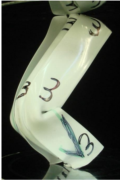
Εικόνα 7 : Χαρακτηριστικό παράδειγμα λυγισμού
