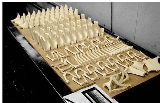
ΠΑΡΑΓΩΓΗ ΜΕΣΩ ΤΡΙΑΣΔΙΑΣΤΑΤΗΣ ΕΚΤΥΠΩΣΗΣ ΚΑΙ ΧΥΤΕΥΣΗΣ ΚΑΛΟΥΠΙΩΝ ΠΟΛΛΑΠΛΩΝ ΑΝΤΙΓΡΑΦΩΝ ΤΩΝ ΤΥΠΩΝ 1,2 ΚΑΙ 3
