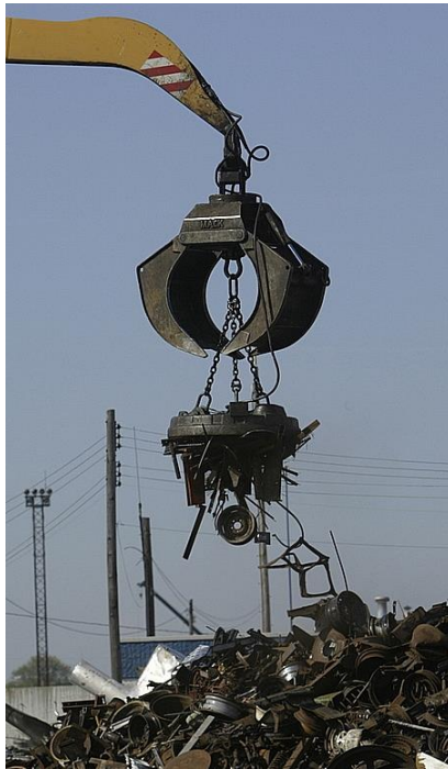
Σχήμα 1-5: Οι μαγνητικές ιδιότητες του χάλυβα απλοποιούν σε μεγάλο βαθμό τον διαχωρισμό [6]
