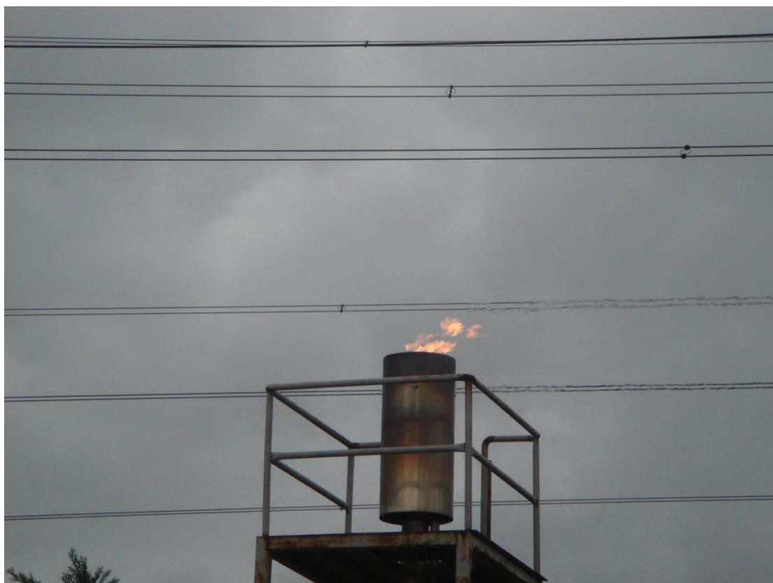
Εικόνα 2. 4 Ο πυρσός καύσης του παραγόμενου από την αναερόβια χώνευση βιοαερίου
