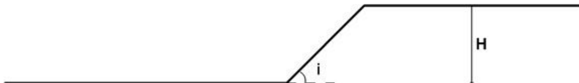
Σχήμα 2.1 Όψη και βασικά μεγέθη μονοκλινούς πρανούς.
