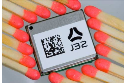
Σχήμα 1.2: Ολοκληρωμένος δέκτης GPS. Το μικρό του μέγεθος διευκολύνει την ενσωμάτωση σε παντός είδους συσκευές. (Wikimedia Commons)
