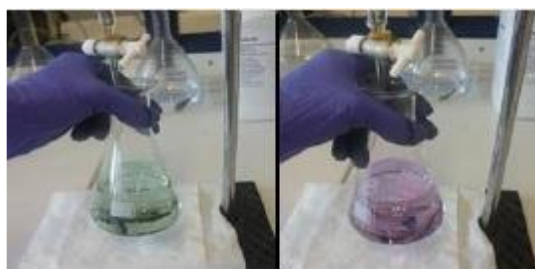
Εικόνα 5.19. Μετά την απόσταξη και πριν την τιτλοδότηση (αριστερά) και μετά την τιτλοδότηση (δεξιά)
