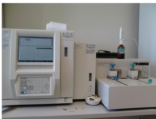
Εικόνα 5.11. Συσκευή μέτρησης TOC
