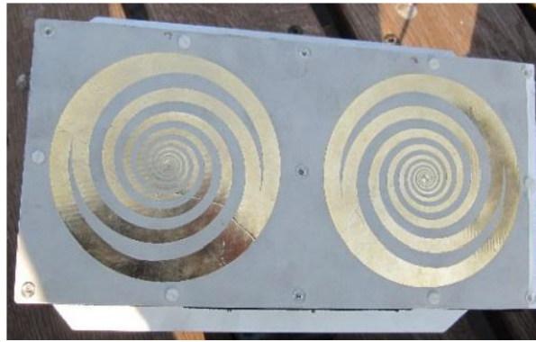
Σχήμα 5.5: Οι σπειροειδείς κεραιές που χρησιμοποιήθηκαν στον πομπό.
