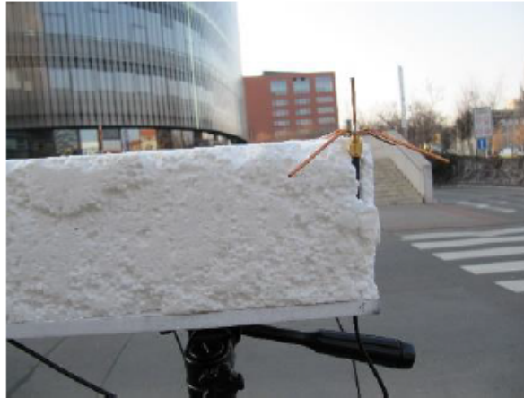
Σχήμα 5.8: Ενδεικτική απεικόνιση ενός μονόπολου που χρησιμοποιήθηκε στον πομπό και στον δέκτη.
