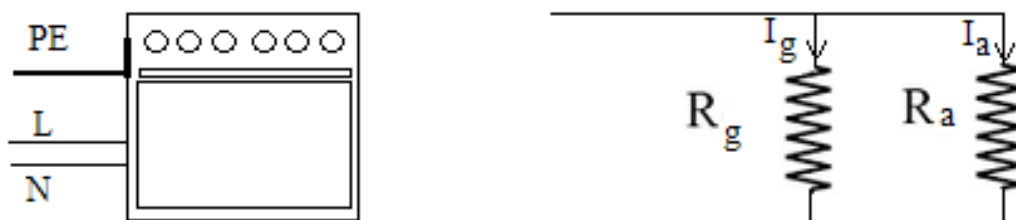
Εικόνα 1: Σχηματικό διάγραμμα γείωσης προστασίας
