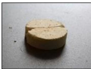
Εικόνα 26: Φωτογραφία παραγόμενου δισκίου, μετά τη θραύση του
