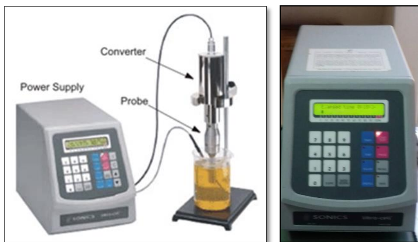
Εικόνα 15: Σχηματική απεικόνιση του Probe Sonicator και φωτογραφία διάταξης εργαστηρίου
