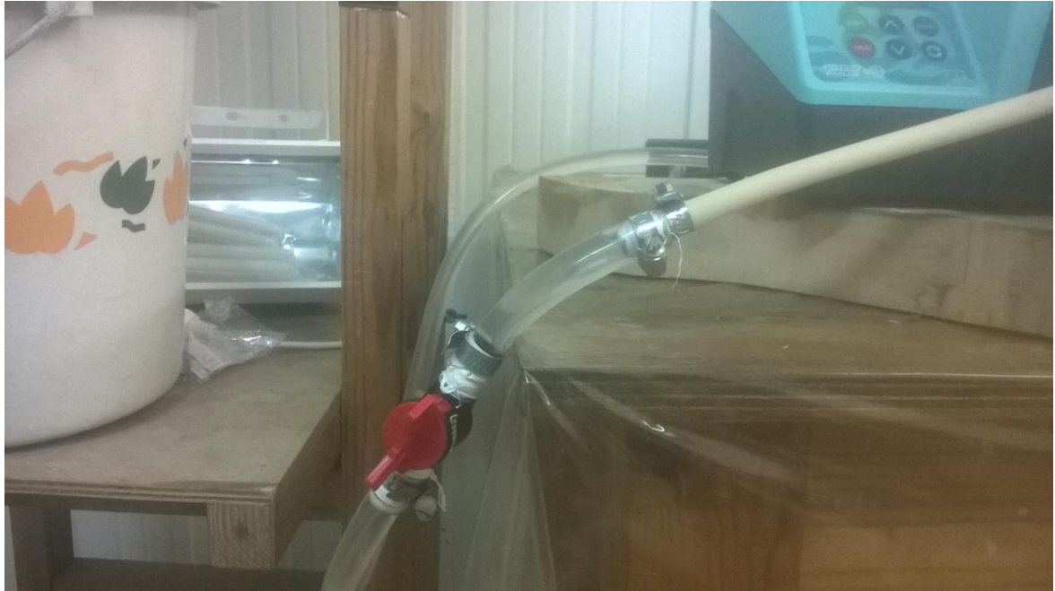
Εικόνα 4.2 δεύτερη βάνα downstream του εύκαμπτου αγωγού, λίγο πριν εισέλθει το ρευστό στην αντλία.
