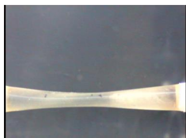
Εικόνα 3.11 Εξέλιξη της διατομής του αγωγού συναρτήσει της θέσης της βάνας για 210 ml/min.
