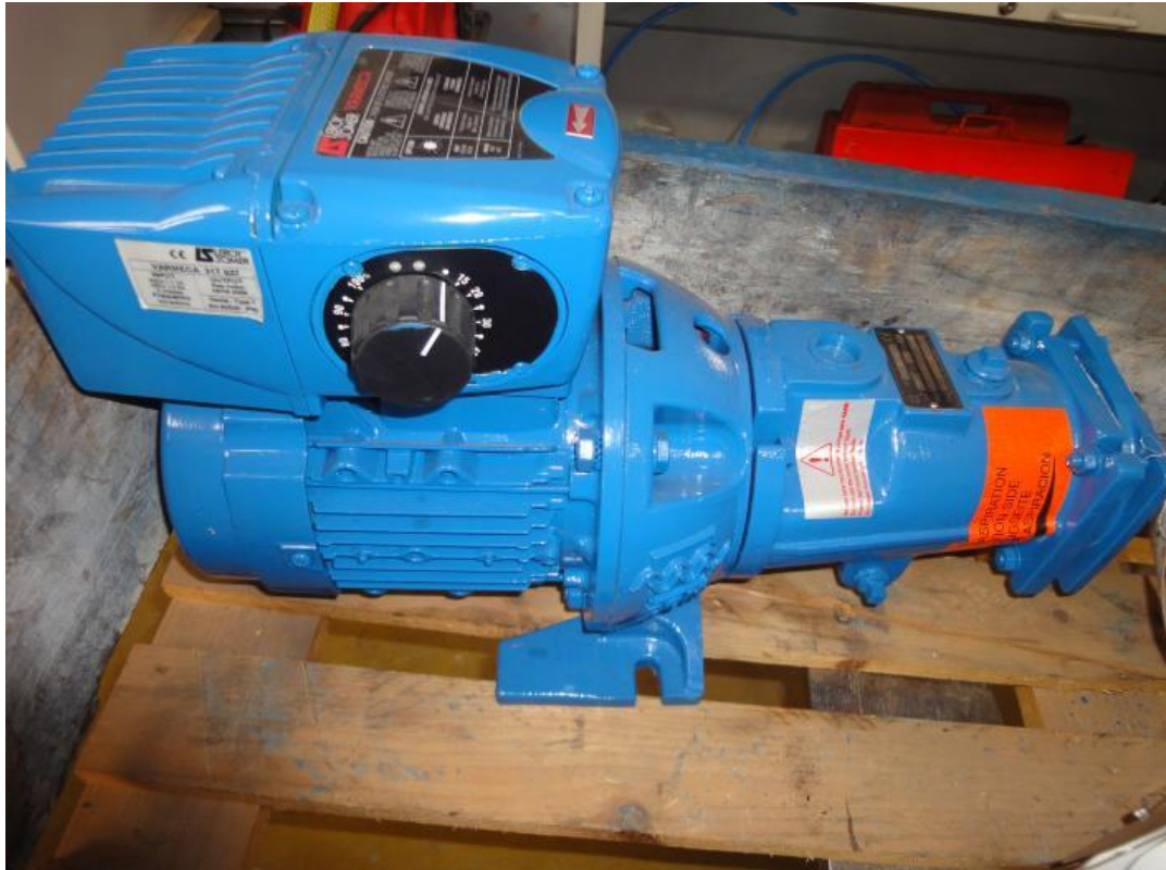
Εικόνα 3.7 Αντλία PCM, series 011M6F, προοδευτικής κοιλότητας (progressive cavity pump).
