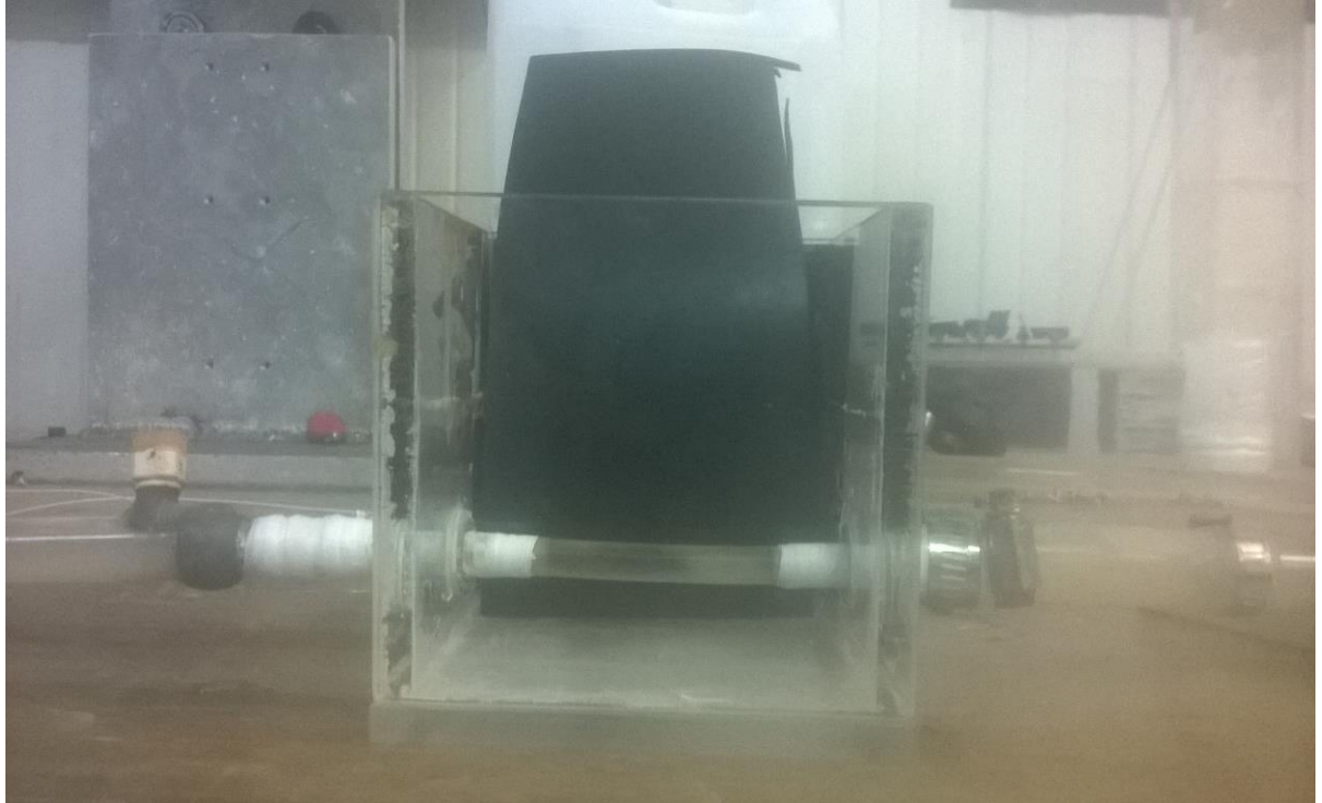
Εικόνα 3.4 Plexiglass δοχείο, μέσα στο οποίο στηρίζεται ο εύκαμπτος αγωγός. Ο αγωγός είναι εκτεθειμένος σε ατμοσφαιρική πίεση. Πίσω από τον αγωγό φαίνεται το μαύρο background που χρησιμοποιήσαμε για καλύτερες λήψεις.
