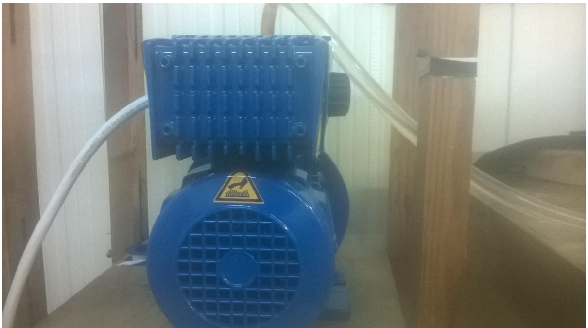
Εικόνα 3.6 Αντλία προοδευτικής κοιλότητας. Αποτελεί την κατάληξη του downstream τμήματος.
