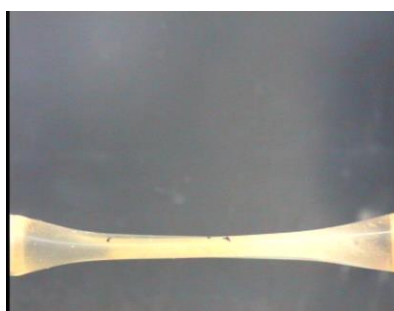
Εικόνα 3.27 Εξέλιξη της διατομής του αγωγού συναρτήσει της θέσης της βάνας για παροχή 300 ml/min.
