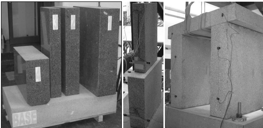
Εικ. 4.2: Φωτογραφίες των διαφόρων δοκιμίων από γρανίτη 125 των οποίων εξετάστηκε η δυναμική συμπεριφορά στο Εθνικό Εργαστήριο Πολιτικών Μηχανικών της Πορτογαλίας.
