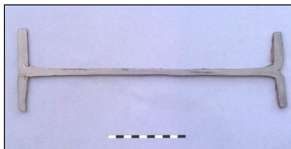
Εικ. 2.8: Σύνδεσμος από το ναό του Επικούριου Απόλλωνα, μετά από λείανση και χημική προσβολή του για την αποκάλυψη της εσωτερικής μακροδομής του 79 .
