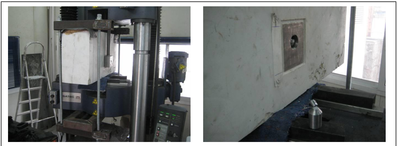
Εικ. 6.7: Φωτογραφία της πειραματικής διάταξης, πριν από την έναρξη μιας δοκιμής (αριστερά), και φωτογραφία με την κατάσταση του εμπολίου, του περιβάλλοντος τμήματος του ασβεστολιθικού τεμαχίου και του πόλου, μετά την ολοκλήρωση μίας δοκιμής.
