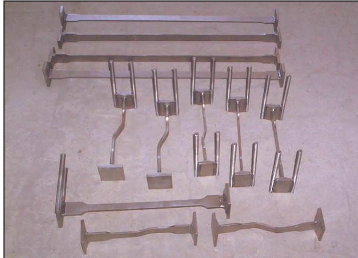
Εικ. 2.13: Σύνδεσμοι από τιτάνιο διαφόρων μορφών που έχουν κατασκευαστεί για τα μνημεία της Αθηναϊκής Ακρόπολης.
