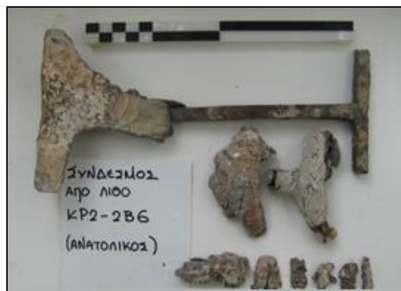
Εικ. 2.4: Σύνδεσμος (και τμήματα του μολύβδου που τον περιέβαλλε) από την κρηπίδα του ναού του Επικούριου Απόλλωνα των Βασσών.
