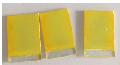
Εικόνα 6. Υμένια \text{TiO}_2 στα οποία έχουν πραγματοποιηθεί 9 κύκλοι SILAR CdS
