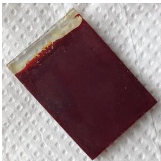
Εικόνα 8. Υμένια \text{TiO}_2 στα οποία έχουν πραγματοποιηθεί 10 κύκλοι SILAR με \text{CdS-ZnS} , στη συνέχεια CBD με \text{CdSe} και τέλος 2 κύκλοι SILAR με \text{ZnS} .
