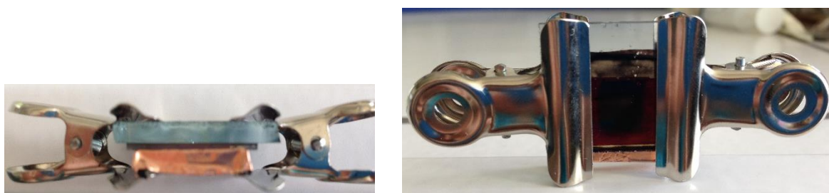
Εικόνα 15. Ηλιακή κυψελίδα σε μορφή σάντουιτς. Η απόσταση μεταξύ ανόδου και καθόδου είναι 1mm .
