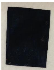
Εικόνα 11. Ηλεκτρόδιο \text{Cu}_2\text{S} σε υπόστρωμα ορείχαλκου.
