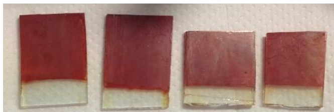
Εικόνα 7. Διαδικασία CBD σε διάφορες χρονικές στιγμές κατά την οποία παρατηρείται σταδιακή αλλαγή του χρώματος των ηλεκτροδίων. Υμένια \text{TiO}_2 στα οποία έχουν πραγματοποιηθεί 10 κύκλοι SILAR CdS-ZnS και CBD με CdSe.
