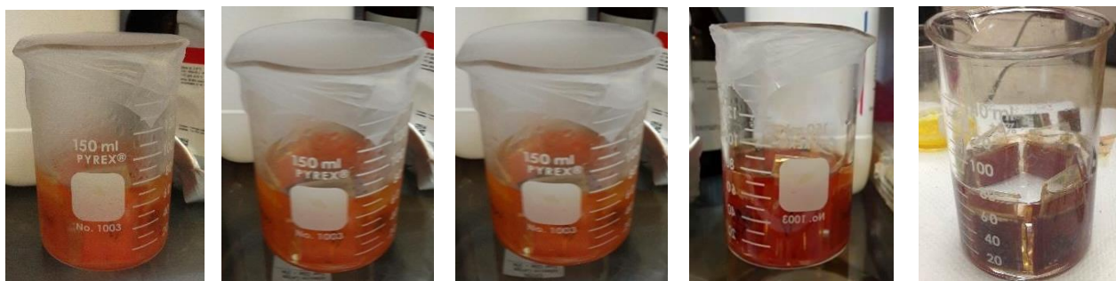
Εικόνα 7. Διαδικασία CBD σε διάφορες χρονικές στιγμές κατά την οποία παρατηρείται σταδιακή αλλαγή του χρώματος των ηλεκτροδίων. Υμένια \text{TiO}_2 στα οποία έχουν πραγματοποιηθεί 10 κύκλοι SILAR CdS-ZnS και CBD με CdSe.
