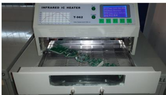
Σχήμα 2-19. Τοποθέτηση του PCB με τα εξαρτήματα στον φούρνο (IR IC Heater T-962) του εργαστηρίου Αυτομάτου Ελέγχου.
