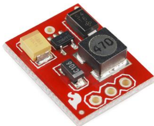
Σχήμα 3-14. Διάταξη μετατροπής της τάσης σε 5V, της Sparkfun.
