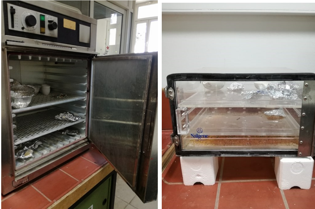
Σχήμα 3.3: Φούρνος ξήρανσης στους 100 οC και ξηραντήρας
