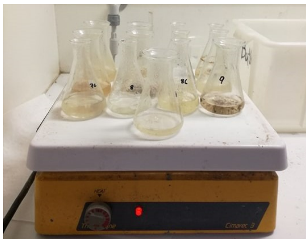
Σχήμα 3.5: Διαδικασία χώνευσης δειγμάτων για μέτρηση ολικού φωσφόρου
