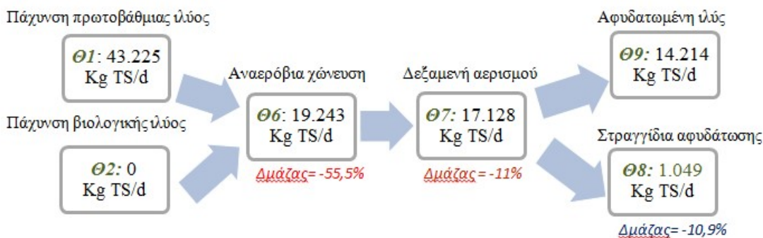
Σχήμα 4.38: Ισοζύγιο μάζας ολικών στερεών στην συμβατική γραμμή για την τρίτη δειγματοληψία
