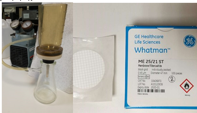
Σχήμα 3.4: Διάταξη διήθησης και μεμβράνες της εταιρίας Whatman
