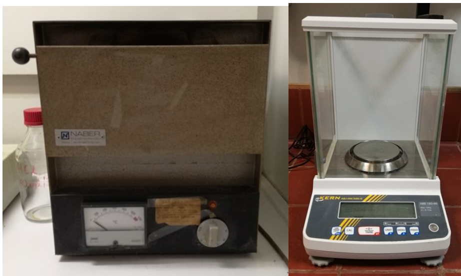
Σχήμα 3.2: Φούρνος 550 °C και αναλυτικός ζυγός
