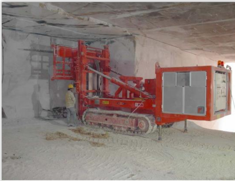
Εικόνα 2.16υ: Αλυσοπρίονο διάνοιξης σηράγγων Fantini GU-70
