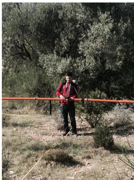
Εικόνα 4.22γγ: Ευρέως χρησιμοποιούμενο μηχάνημα EM ( CMD4- gf instruments) κατά τη διεξαγωγή γεωφυσικής έρευνας (2015, εργαστήριο εφαρμοσμένης γεωφυσικής, Σχολή Μηχ. Μετ. - Μετ., Ε.Μ.Π. )
