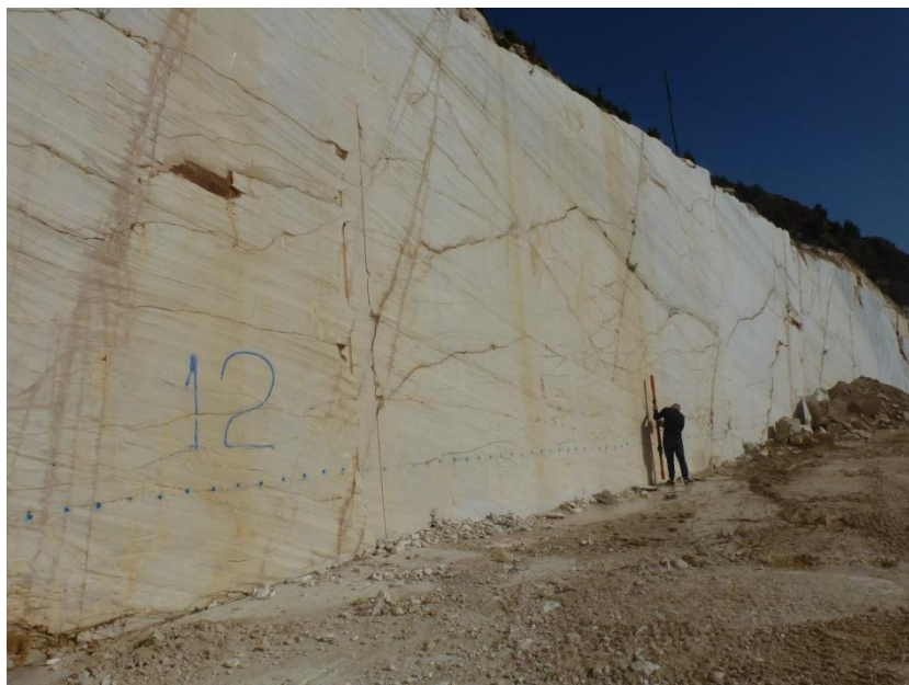
Εικόνα 6.2xxx: Μετρήσεις με το ηλεκτρομαγνητικό όργανο στο Λατομείο Διονύσου. Οι μπλε τελείες αποτελούν τη συνεχή γραμμή μετρήσεων με βήμα 0,5m. ( Λατομείο Διονύσου, Ιανουάριος 2016)
