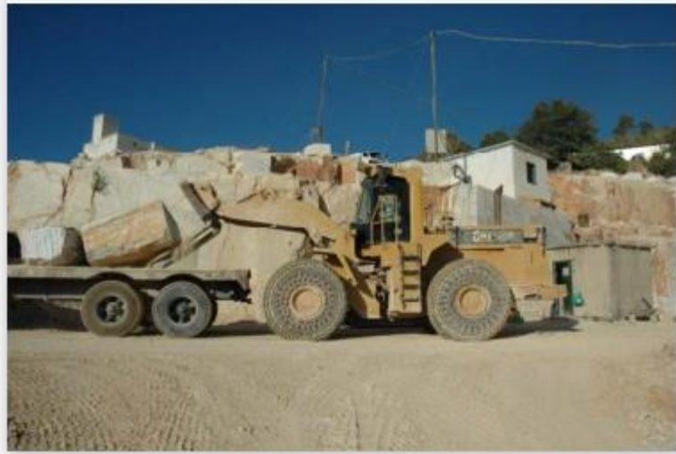
Εικόνα 2.14s: Φόρτωση ογκομαρμάρου προς μεταφορά με φορτωτή της εταιρίας ( CAT 980F)
