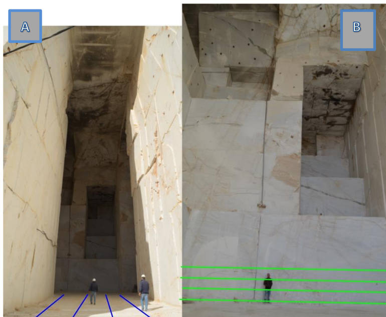
Εικόνα 6.7ccsc: Α) Με μπλε χρώμα γραμμής απεικονίζεται η μηκογραμμή κατά την οποία ελήφθησαν οι μετρήσεις με το γεωραντάρ στο δάπεδο της εισόδου του υπογείου της εξόρυξης. Β) με πράσινο χρώμα απεικονίζονται οι μηκογραμμές κατά τις οποίες ελήφθησαν οι μετρήσεις στο μέτωπο εξόρυξης του υπογείου.
