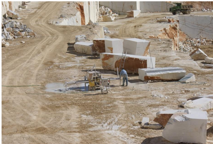
Εικόνα 2.13α: ορθογωνισμός όγκου με συρματοκοπή
