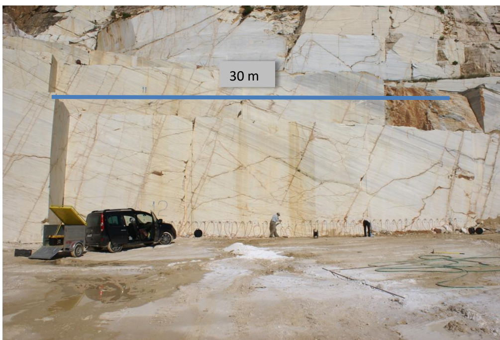
Εικόνα 6.4zzz: Αρχικός σχεδιασμός του τρόπου απόκτησης των δεδομένων με την ηλεκτρική τομογραφία. Τα ηλεκτρόδια τοποθετούνται κάθετα στο μάρμαρο. (Λατομείο Διονύσου, Ιανουάριος 2016)
