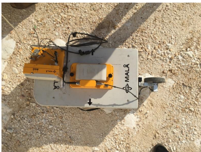
Εικόνα 6.dddd: Απεικόνιση διάταξης Γεωραντάρ της MALA Geoscience με κεραία 250MHz, όπως χρησιμοποιήθηκε στην παρούσα γεωφυσική έρευνα (Λατομείο Διονύσου, Ιανουάριος 2016)
