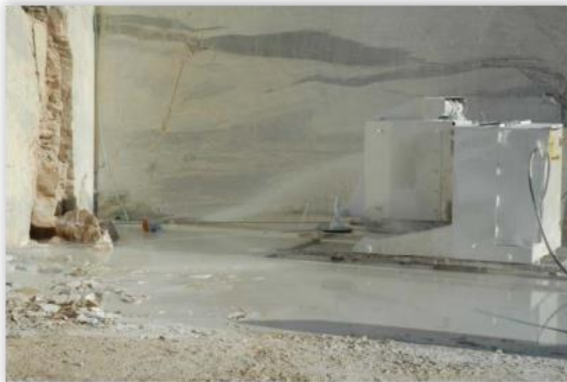
Εικόνα 2.7k: Συρματοκοπή κατά οριζόντια τομή στο ύψος του δαπέδου
