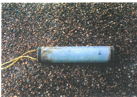
Εικόνα 5.15sss: A) στο αριστερό μέρος βλέπουμε τη φωτογραφία από μια κεραία που χρησιμοποιήθηκε για τις τομογραφίες στις γεωτρήσεις. Β) Στο δεξί μέρος βλέπουμε την διάταξη του συστήματος για την απόκτηση των δεδομένων. Στη διάταξη υπάρχουν μια κεραία πομπός, μια κεραία δέκτης που τοποθετούνται εντός των γεωτρήσεων, ένας ενισχυτής χαμηλού θορύβου για την απαλοιφή θορύβων και την ενίσχυση του σήματος και μέσω ενός συστήματος ανάλυσης τα δεδομένα παίρνουν στον υπολογιστή προκειμένου να επεξεργαστούν.
