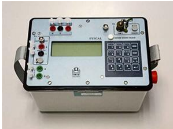
Εικόνα 4.12οο: Όργανο μέτρησης της ηλεκτρικής αντίστασης
