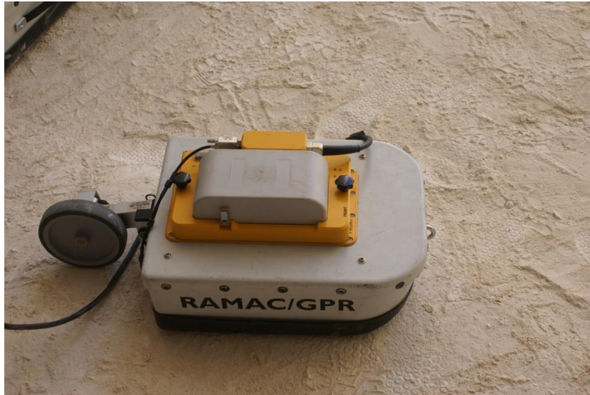
Εικόνα 4.27ddd: Απεικόνιση ολοκληρωμένου συστήματος Γεωραντάρ , όπως αυτό χρησιμοποιήθηκε κατά τη Γεωφυσική Έρευνα στο λατομείο Διονύσου ( 2016, Σχολή Μηχ. Μετ. -Μετ. , Ε.Μ.Π.)
