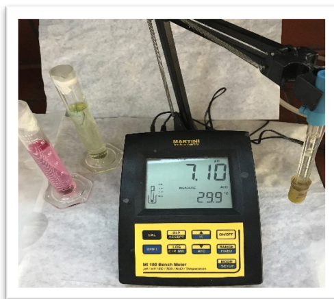
Εικόνα 27: Συσκευή Multiparameter Bench Meter για τη μέτρηση του pH των δειγμάτων
