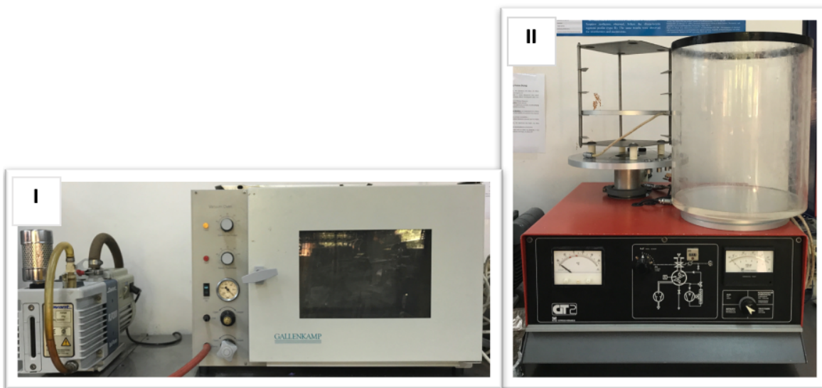
Εικόνα 20: Συσκευή ξήρανσης υπό κατάψυξη (I) και υπό κενό (II)
