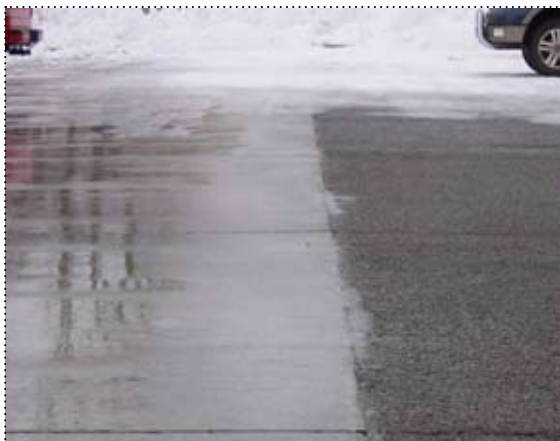
Εικόνα 6. Αριστερά συμβατικό σκυρόδεμα, δεξιά υδατοπερατό σκυρόδεμα, πηγή Iowa State University, Ames, IA
