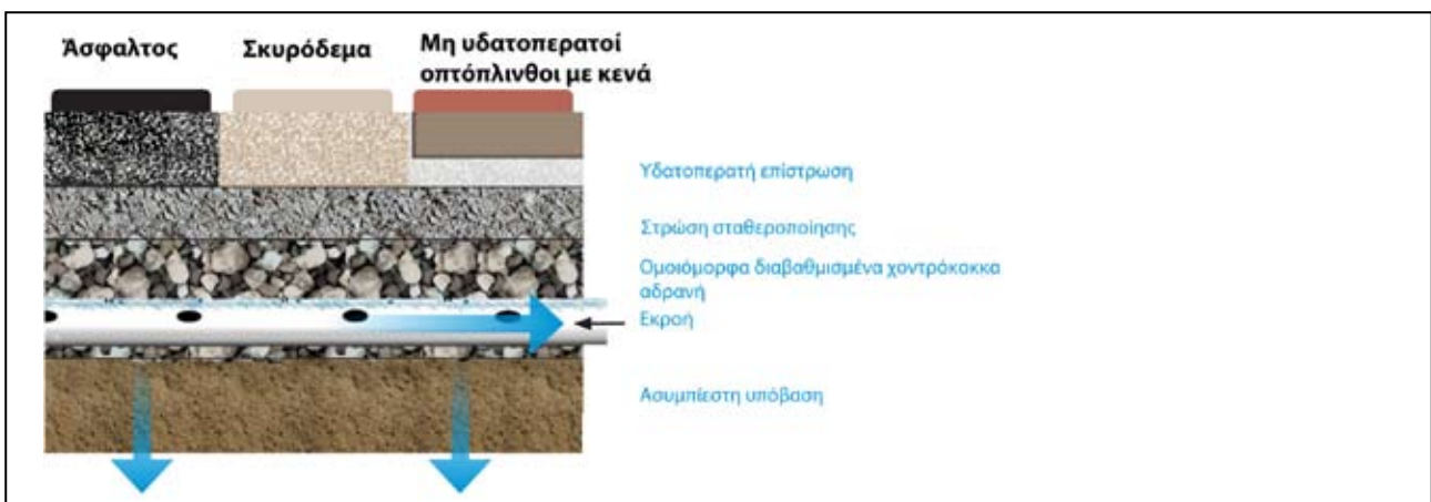
Σχήμα 26 , Υδατοπερατή επίστρωση και μερική διήθηση, αναπροσαρμογή από πηγή VHB/Vanasse Hangen Brustlin, Inc. 2013
