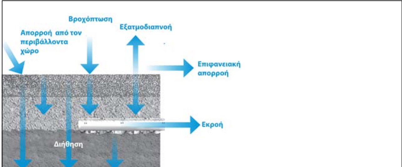
Σχήμα 24, Μεταβλητές υδατικού ισοζυγίου για υδατοπερατή επίστρωση, αναπροσαρμογή από πηγή VHB/Vanasse Hangen Brustlin, Inc. 2013
