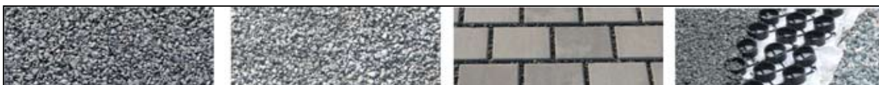
Εικόνα 5 , Υδατοπερατές επιστρώσεις / από αριστερά προς τα δεξιά υδατοπερατή άσφαλτος, υδατοπερατό σκυρόδεμα, μη υδατοπερατοί οπτόπλινθοι με κενά, πλακόστρωση με κάνναβο από πλαστικό ή σκυρόδεμα
