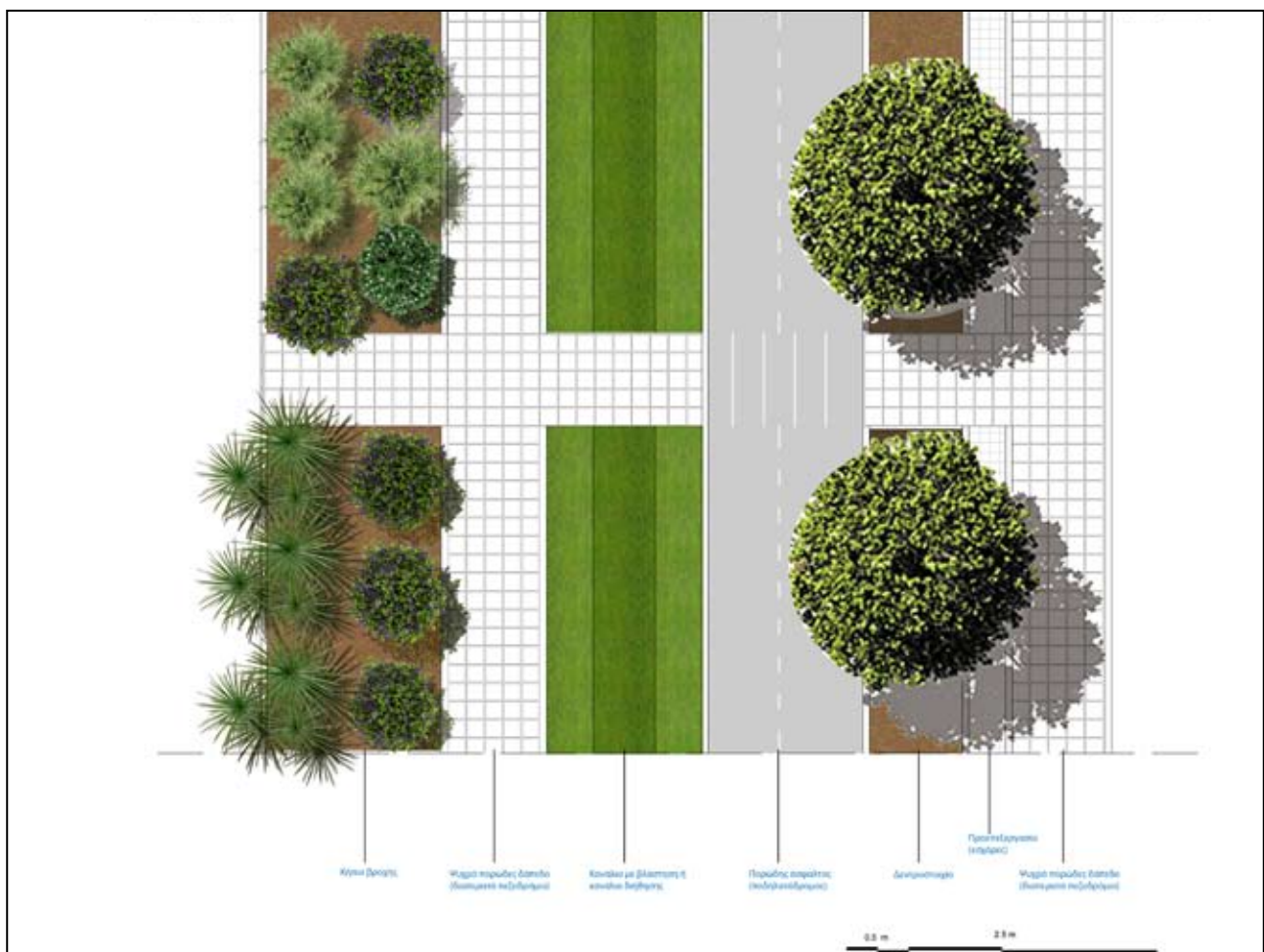
Σχέδιο 2, Τομή όπου διακρίνονται οι ζώνες διήθησης περιμετρικά του Πάρκου Τρίτση
